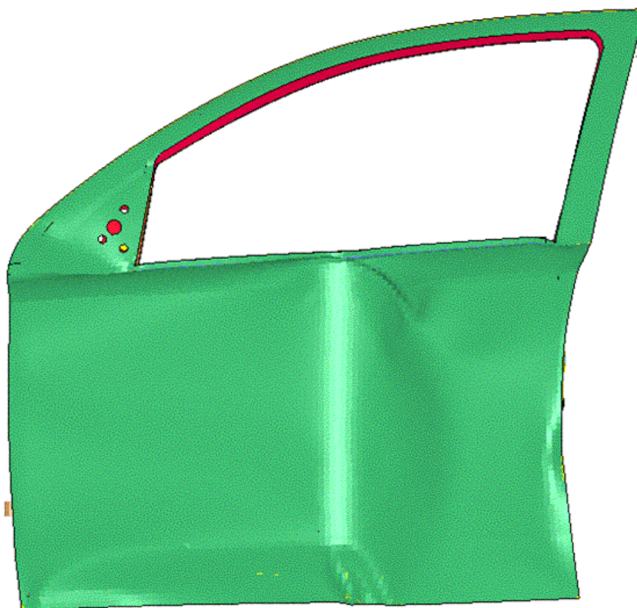
Figura 6.33 –Conjunto de porta após simulação de intrusão lateral – proposta 04.
