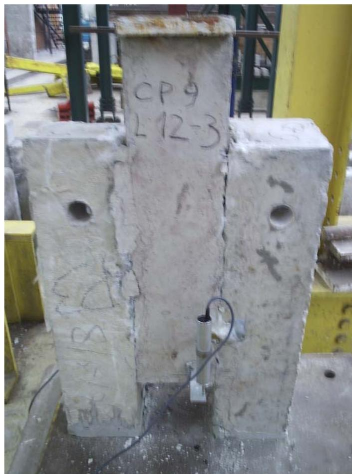
Figura 4.18 - Aspecto do exemplar E9L 12-3 após a ruptura.
