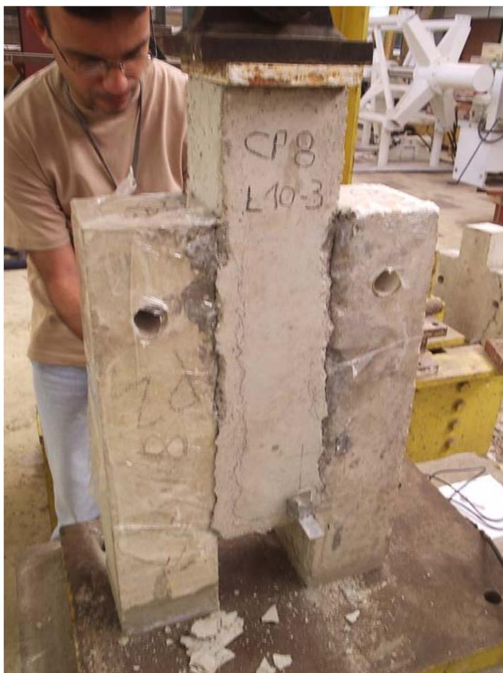
Figura 4.17 - Aspecto do exemplar E8L 10-3 após a ruptura.
