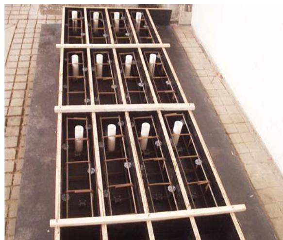
Figura 3.9 - Vista geral das fôrmas usadas para a concretagem dos elementos laterais dos espécimes.
