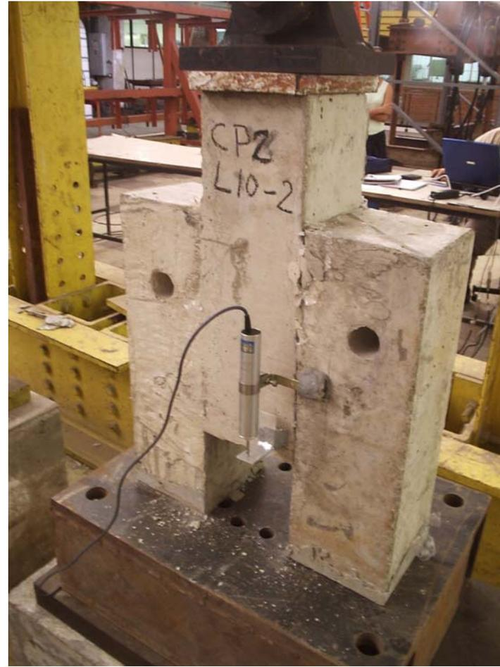
Figura 4.14 - Aspecto do exemplar E2L 10-2 após a ruptura.
