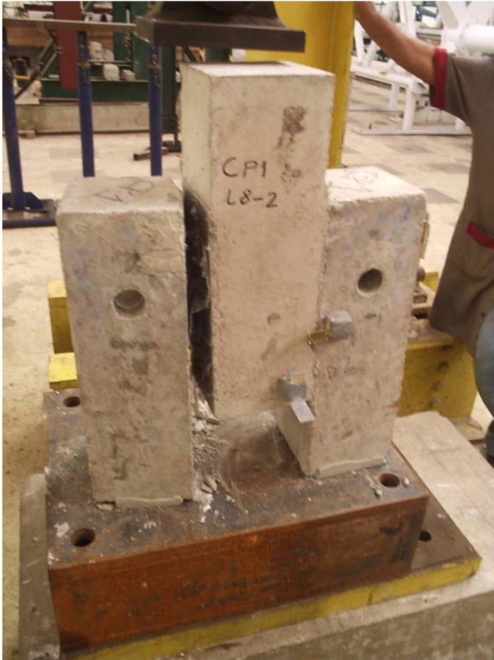
Figura 4.13 - Aspecto do exemplar E1L 8-2 após a ruptura.
