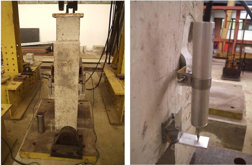
Figura 3.15 - Transdutores de deslocamento utilizados nos ensaios.
