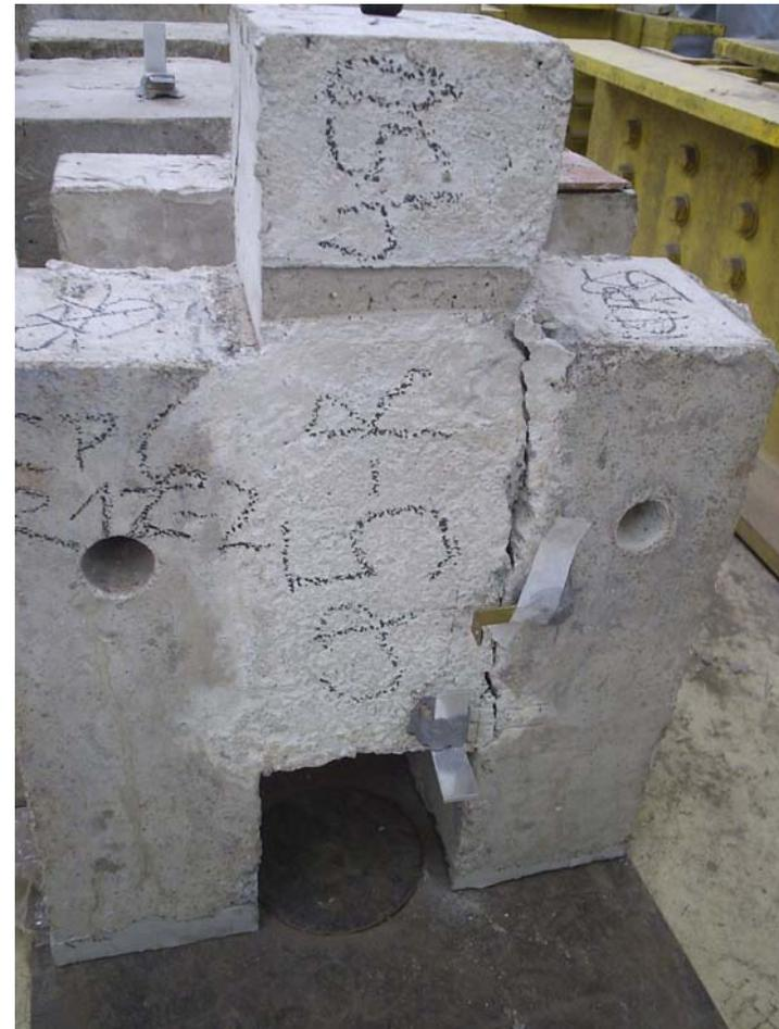
Figura 4.16 - Aspecto do exemplar E5R 10-2 após a ruptura.
