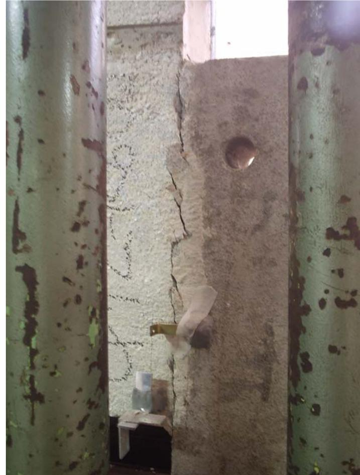
Figura 4.20 - Aspecto do exemplar E12R 12-3 após a ruptura.
