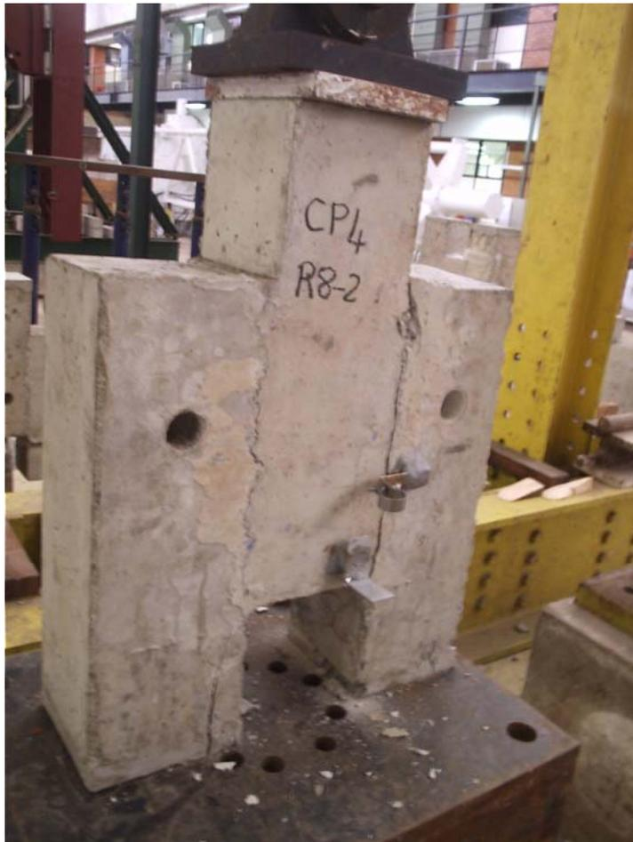
Figura 4.15 - Aspecto do exemplar E4R 8-2 após a ruptura.
