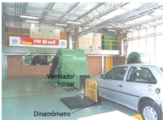
Figura 4.1: Dinamômetro de chassi da Volkswagen do Brasil (o veículo da foto é apenas ilustrativo).
