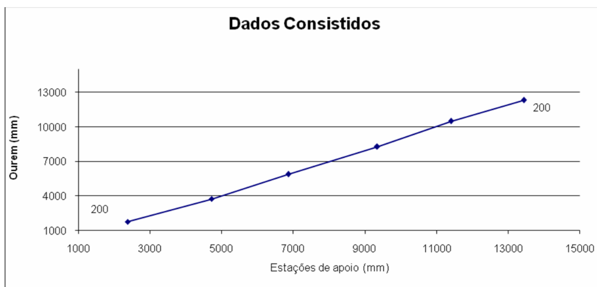
Figura 3.2 - Verificação da homogeneidade dos dados – exemplo de curva de dupla massa para definir similaridade hidrológica com o posto de Ourém – 00147016 – sub-bacia 31
