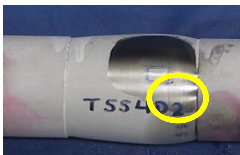
(c) TSS4D14* (Rompimento localizado longitudinal do material)
