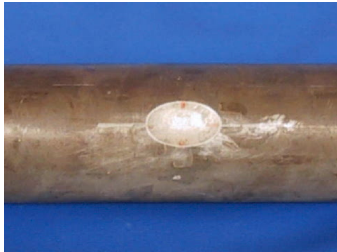
Figura 3.3 – Modelo T3D com defeito induzido.
