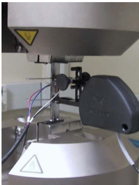
Figura 3.17 – Corpo de prova de tração instrumentado e pronto para a realização do ensaio de tração.
