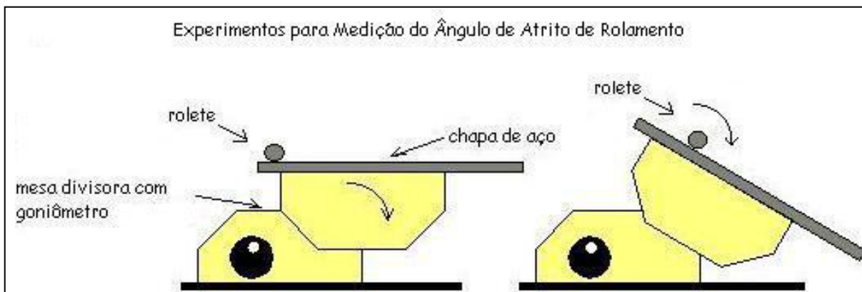
Figura 4.18 – Ilustração do Experimento para Levantamento das Características de Atrito do Rolete.
