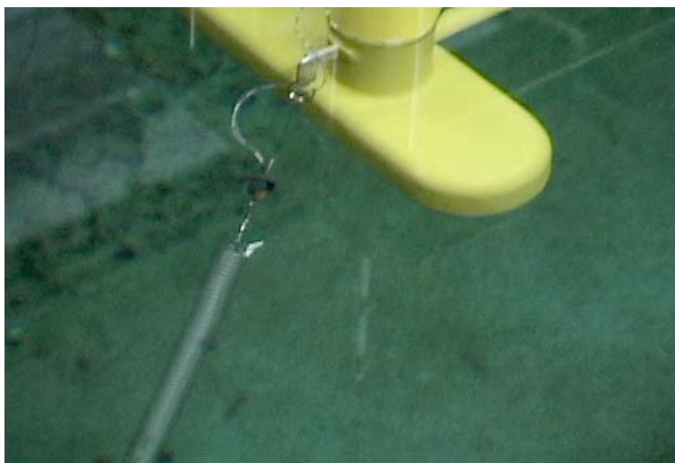
Figura 5.46 – Detalhe de como é presa a linha de amarração da plataforma, com a célula de carga em forma de anel.
