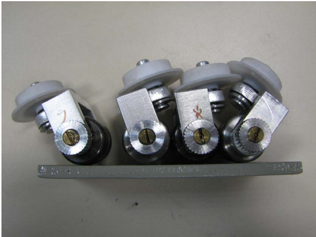
Figura 7.3 – Montagem da Base Magnética para o Ensaio no Seco.
