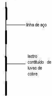
Detalhe da linha de aço mais lastro
