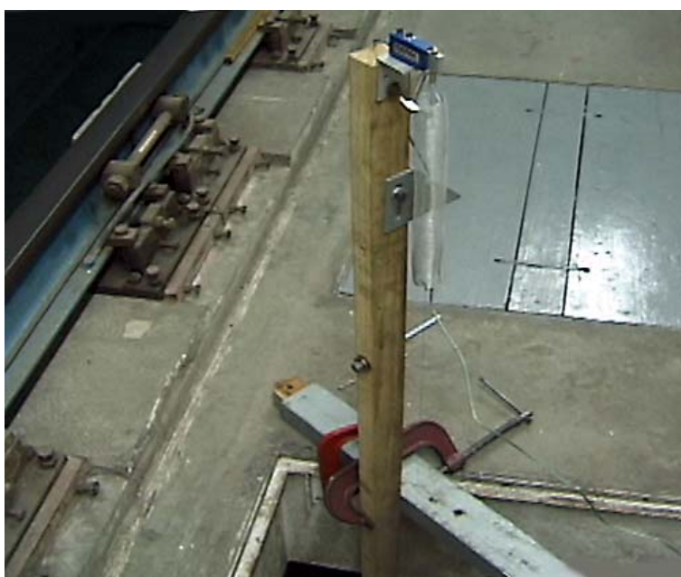
Figura 5.47 – Detalhe da linha de amarração presa à mola com a célula de carga no final.
