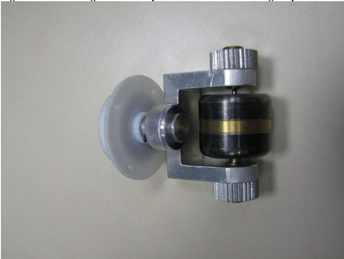
Figura 4.34 – Base Magnética usada nos Ensaio no Laboceano.
