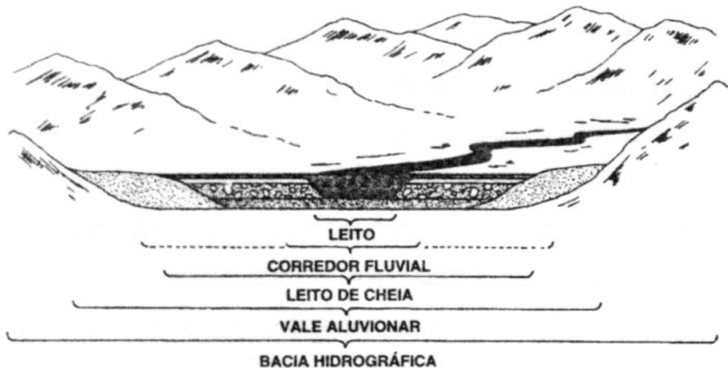
FIG. 36 – CORTE TRANSVERSAL DE UM VALE NO ÂMBITO DA BACIA HIDROGRÁFICA FONTE: Saraiva, 1999
