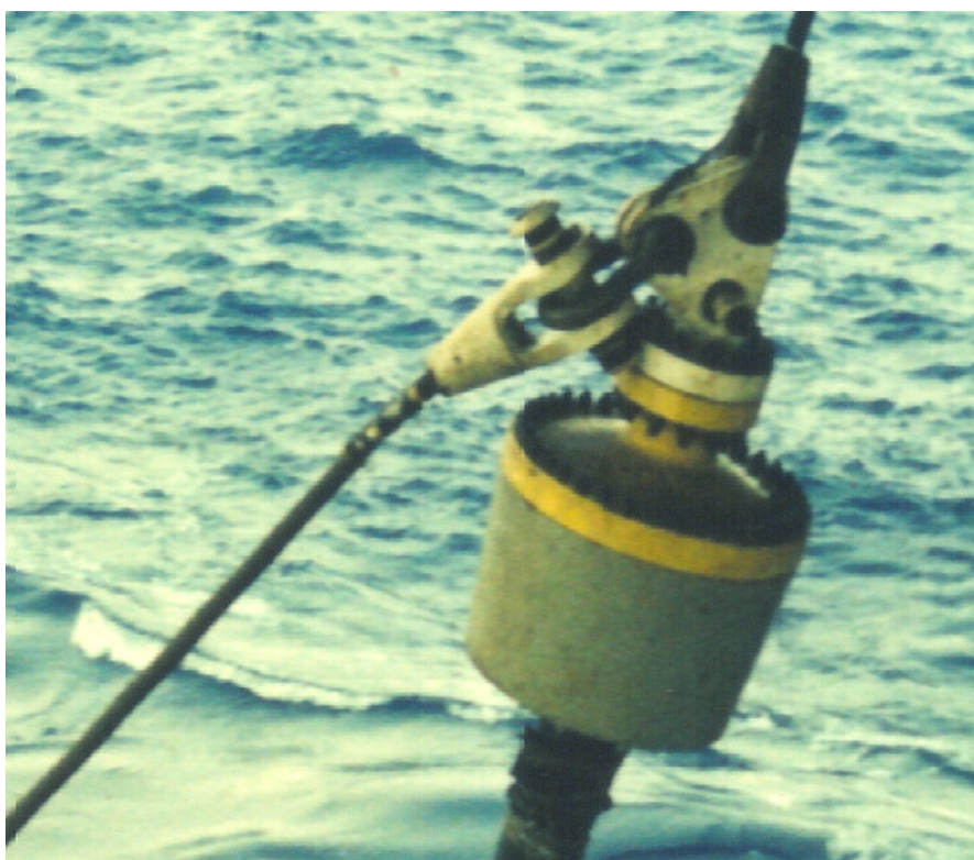
Figura 89 Vista da ferramenta acoplada ao flange da flex-joint utilizada para transferência do topo do SCR entre as unidades, através de cabos de aço, e para operação de pull-in .
