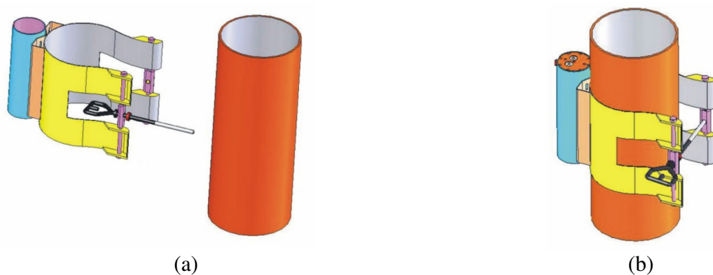
Figura 40 - Receptáculo de Fixação no Riser (a) antes de instalar e (b) depois de instalado com a USM.
