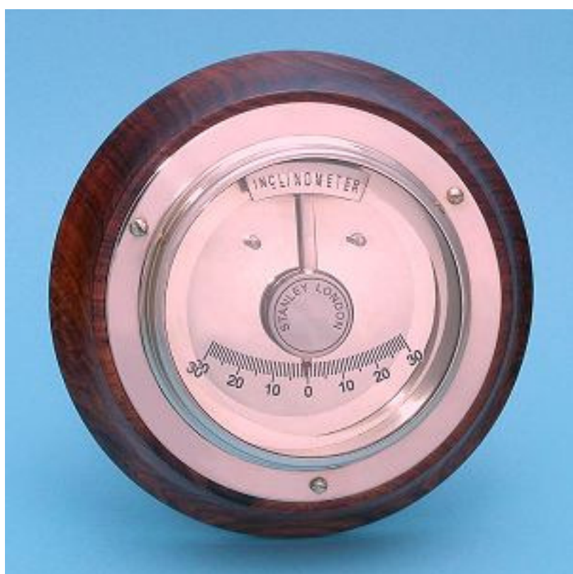
Figura 22 - Inclinômetro do tipo pendular.
