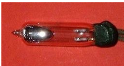
Figura 21 - Exemplo de uma chave de mercúrio.
