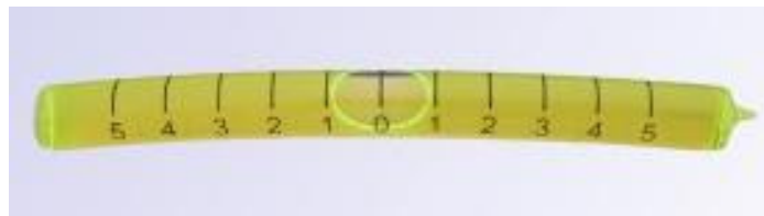
Figura 15 - Medidor de nível do tipo bolha de gás no líquido.
