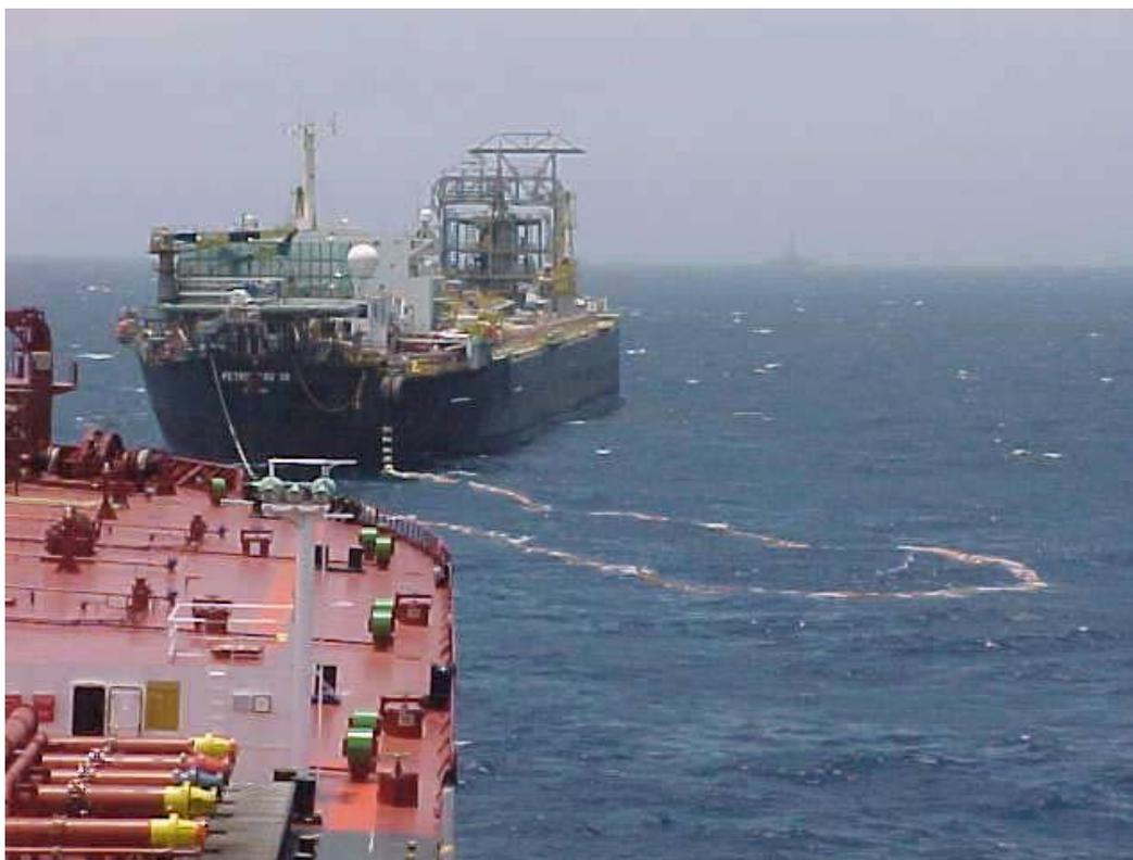
Figura 1.1: Foto tomada durante uma operação de offloading.
