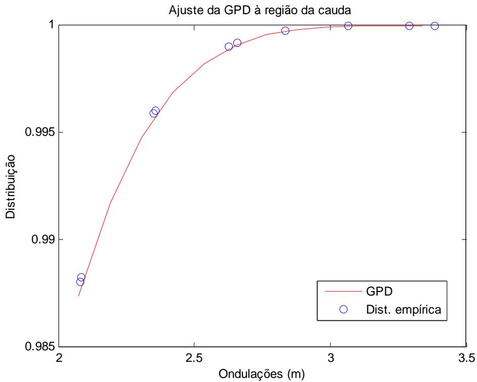
Figura 5.39: Ajuste da GPD aos dados de ondulações.
