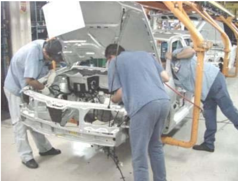
Fig. 4.3 - Sistema tradicional de posicionamento do operador
