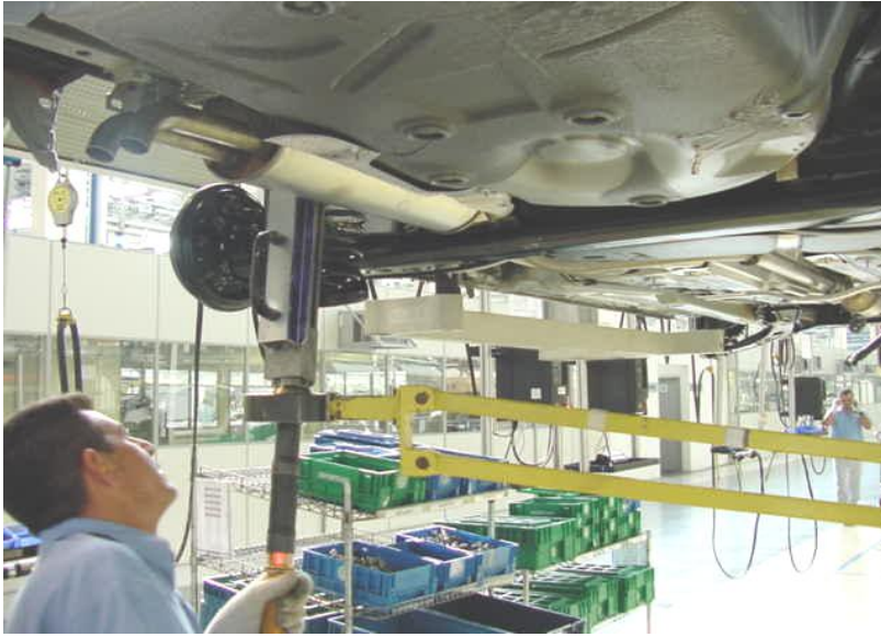
Fig. 4.16 - Estação de verificação das fixações
