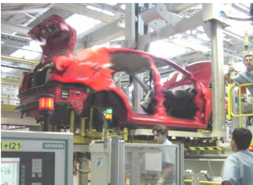
Fig. 4.13 - Estação de acoplamento com a carroceria
