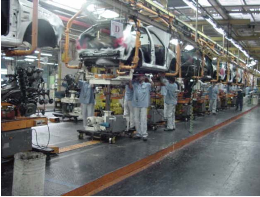
Fig. 4.5 - Time de montagem do conjunto Dress up - eixo traseiro.
