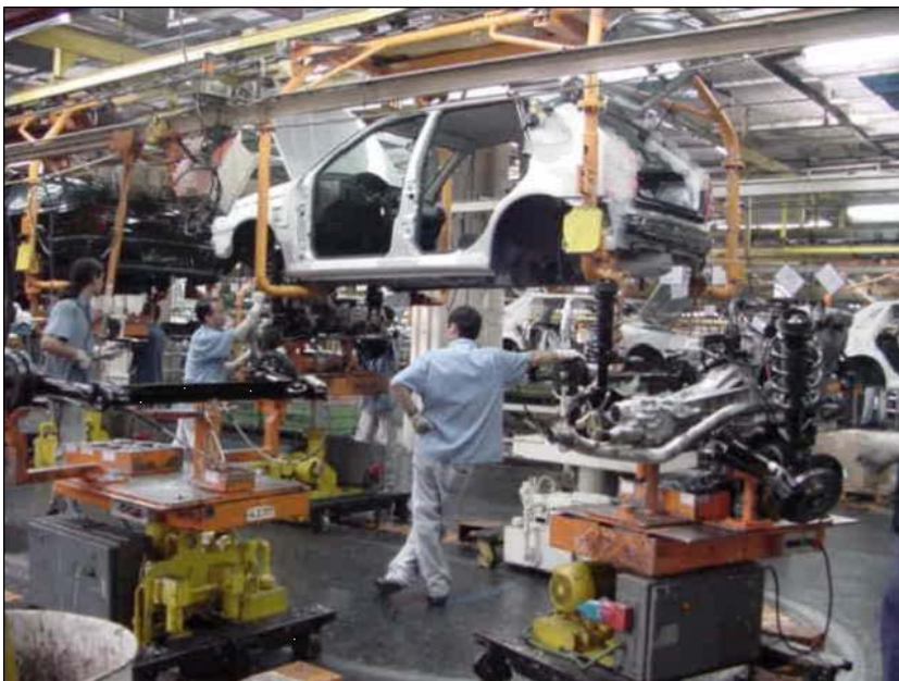
Fig. 4.4 - Montagem do conjunto Dress up - eixo traseiro
