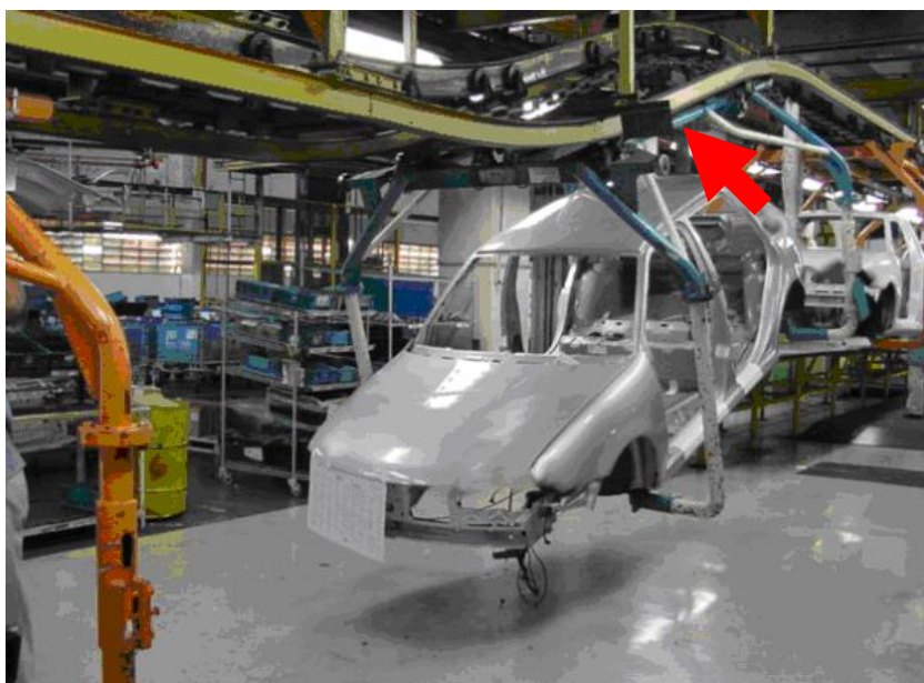
Fig. 1.7 – Elefante sem controle de velocidade e altura.
