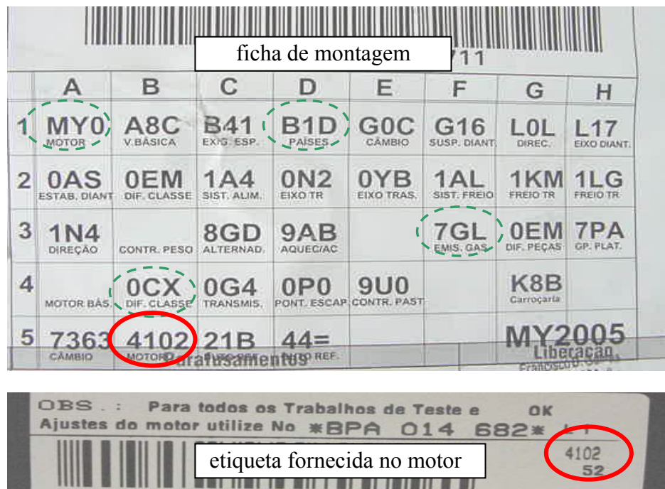
Fig. 2.2 – Sistema de seqüenciamento eletrônico de peças
