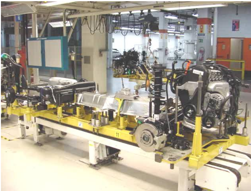
Fig. 4.12 - Conjunto placa do Fahrwerk .
