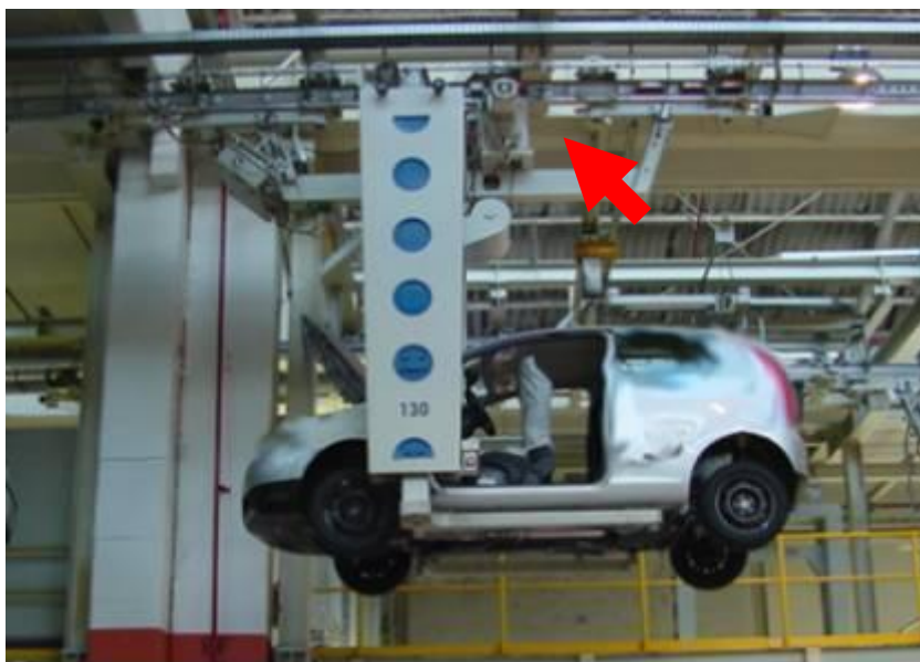
Fig. 1.6 – Elefante com controle de velocidade e altura.
