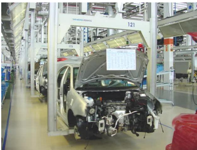
Fig. 4.8 - Sistema inovador com elefantes com regulagem de altura
