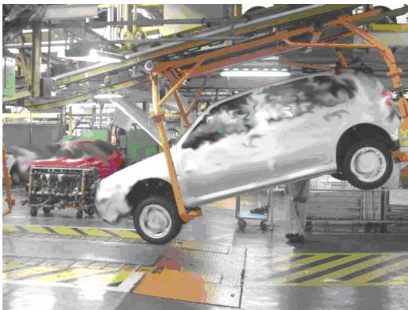
Fig. 4.1 - Sistema tradicional com veículo inclinado
