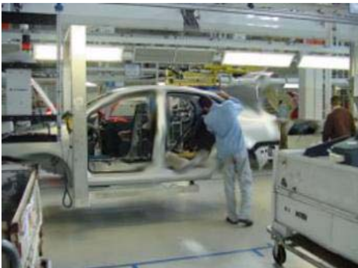
Fig. 4.20 – Sistema inovador de elefantes (o elefante se adapta a altura)
