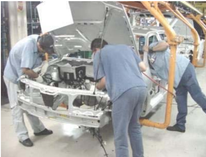
Fig. 4.19 – Sistema tradicional de elefantes (o operador se adapta a altura)
