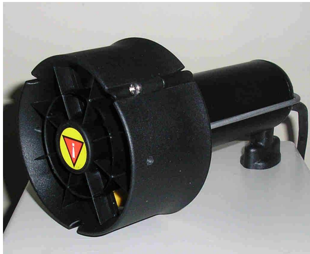
Figura 4.4 - Foto do propulsor BTD 150.
