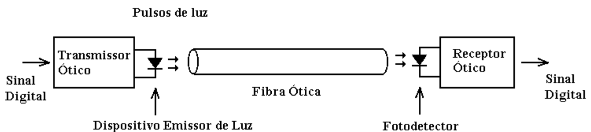
Figura 3.3 - Sistema de transmissão binária ponto-a-ponto por fibra ótica
