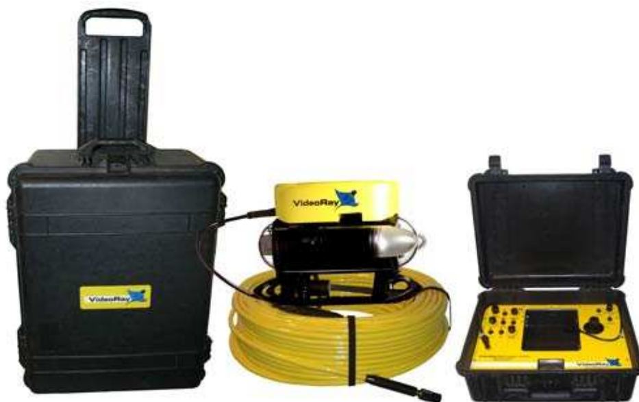
Figura 2.2 – ROV fabricado pela VideoRay com seus equipamentos de superfície.
