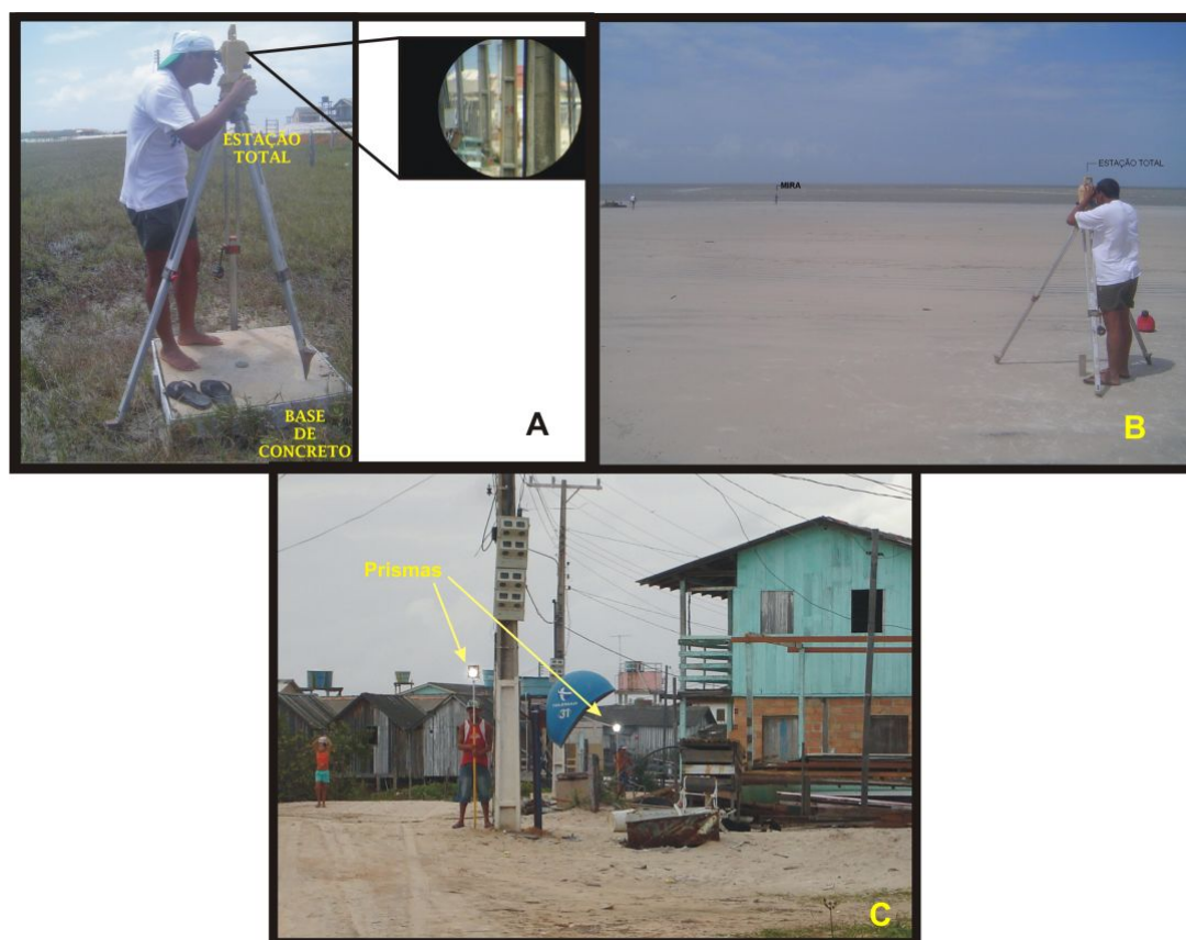
Figura 4.2: Estação Total posicionada sobre uma base de concreto preparada para a visada (A); Perfil topográfico ao longo da zona de intermaré da praia de Ajuruteua sob vários ângulos (B); e (C) Leitura nos prismas nos pontos estabelecidos nos postes.
