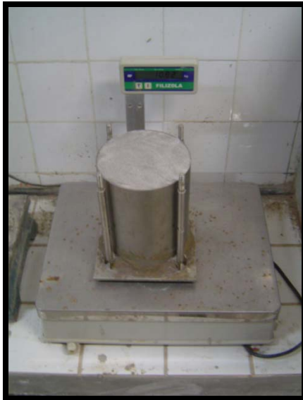
Figura 4.10: Cilindro com os sedimentos pesados em balança.
