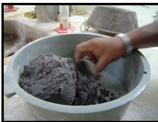
Figura 4.14: Retirada do material úmido usado para a obtenção do teor de umidade.
