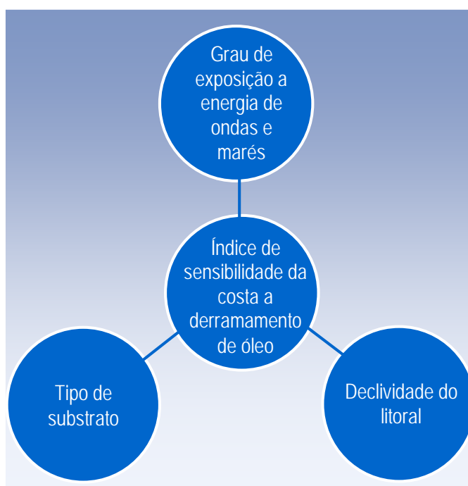
Figura 3.2: Fluxograma mostrando as informações necessárias para a classificação da zona costeira quanto a seu índice de sensibilidade ambiental a derramamentos de óleo.
