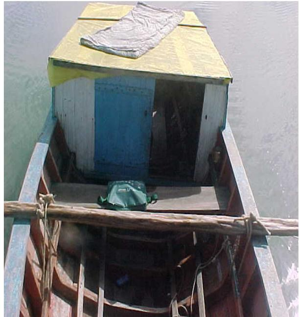
Figura 36: Pedaço de madeira atravessado sobre a proa do barco.
