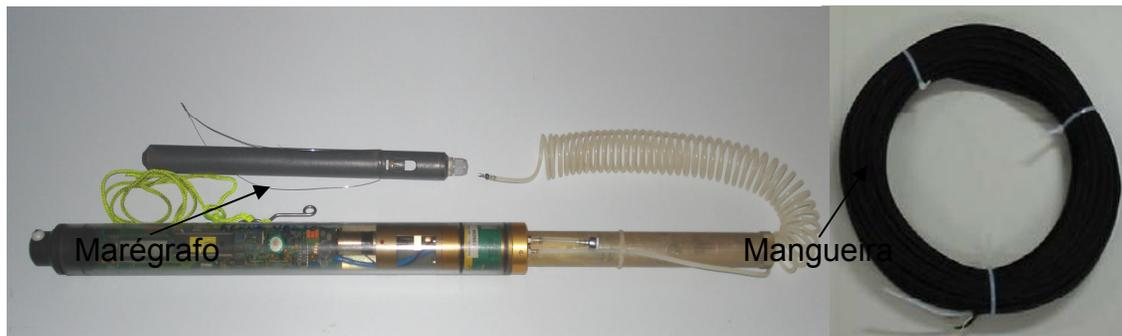
Figura 39: Marégrafos Orphirmedes da marca OTT-Hidrometrie
