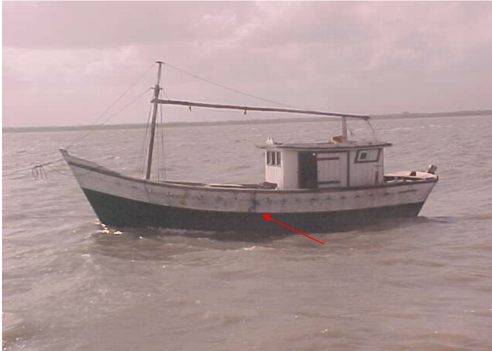
Figura 35: Barco de pequeno porte utilizado para coleta dos dados de corrente (seta vermelha indica o local que foi amarrado o correntógrafo).
