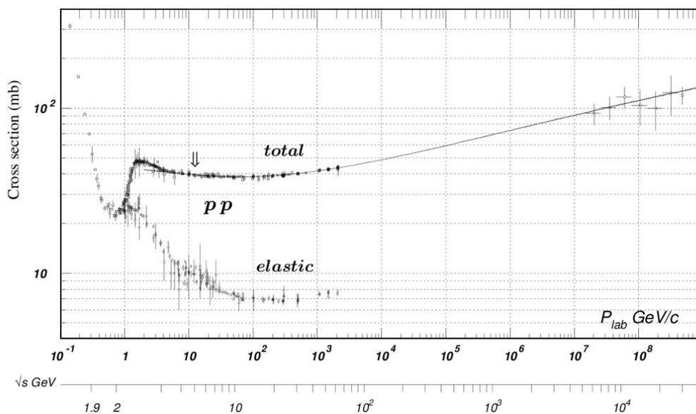
Figura 2.1: Seção de choque total e elástica em colisões de próton-próton como função do momentum do feixe no sistema de laboratório e da energia do centro-de-massa (figura retirada do *Particle Data Group*, PDG).
