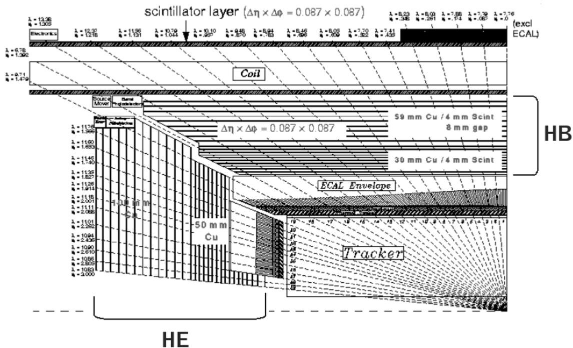
Figura 3.8: Calorímetro hadrônico. Os valores correspondem à separação em pseudo-rapidez do barril (HB) e das tampas (HE).
