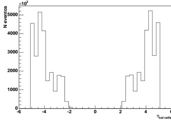
Figura 4.16: Distribuição da pseudo-rapidez das partículas marcadas no calorímetro nos eventos com lacuna de rapidez de dupla difração (DD) (com corte na energia das células,  $E_{cells} \geq 1.4 GeV$  para o barril e  $E_{cells} \geq 1.1 GeV$  para as tampas).
