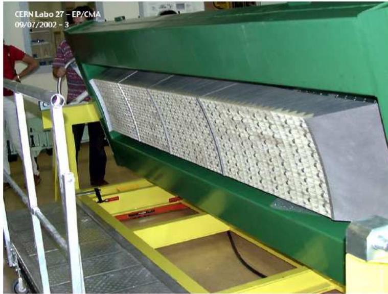
Figura 3.7: Super-módulo real que será montado no ECAL.
