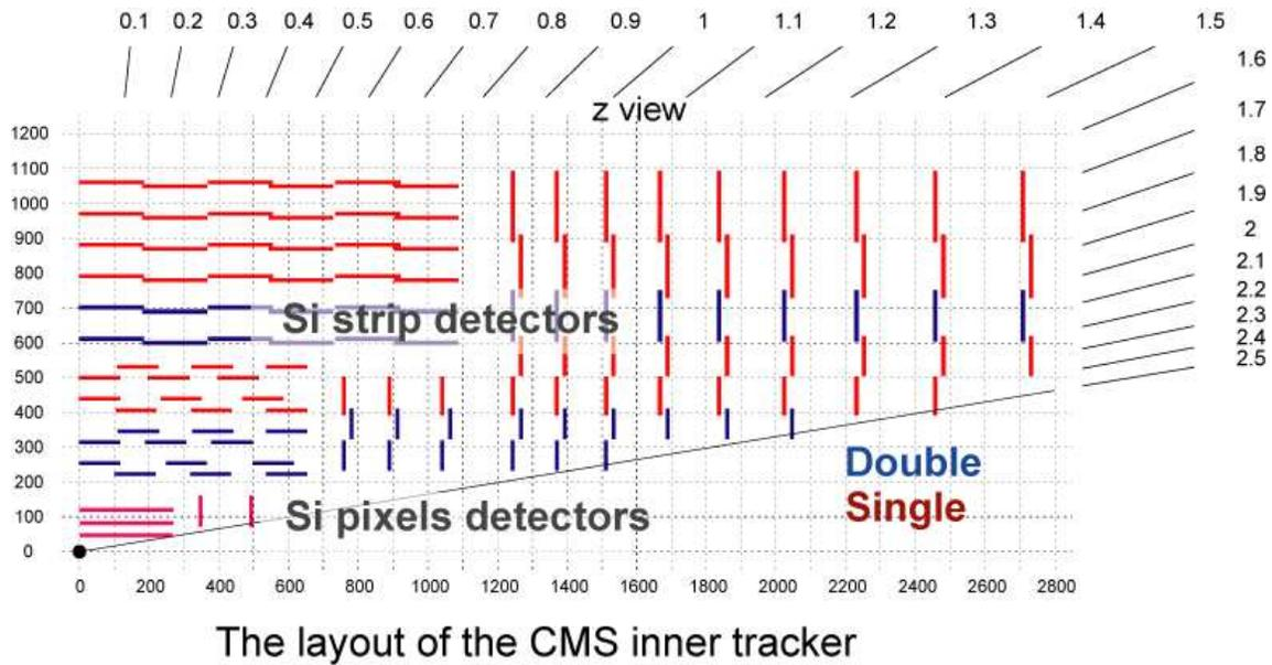
Figura 3.4: Um quarto da seção transversal do detector de trajetórias. Os valores correspondem a separação em pseudo-rapidez. No eixo  $-x$ , o comprimento em centímetros e no eixo  $-y$ , o raio (em cm).
