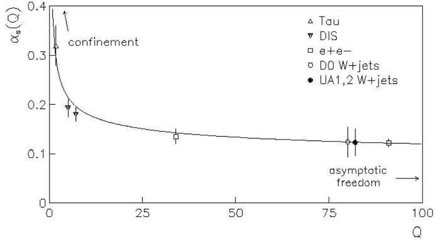
Figura A.3: Comportamento da constante de acoplamento forte ( $\alpha_s$ ) como função da energia  $Q$ . A linha sólida ilustra o comportamento de  $\alpha_s$  em ordem dominante dado pela equação (A.2). Para pequenos  $Q$ , o acoplamento é grande, resultando no confinamento, mas diminui para altos  $Q$ , levando na liberdade assintótica.
