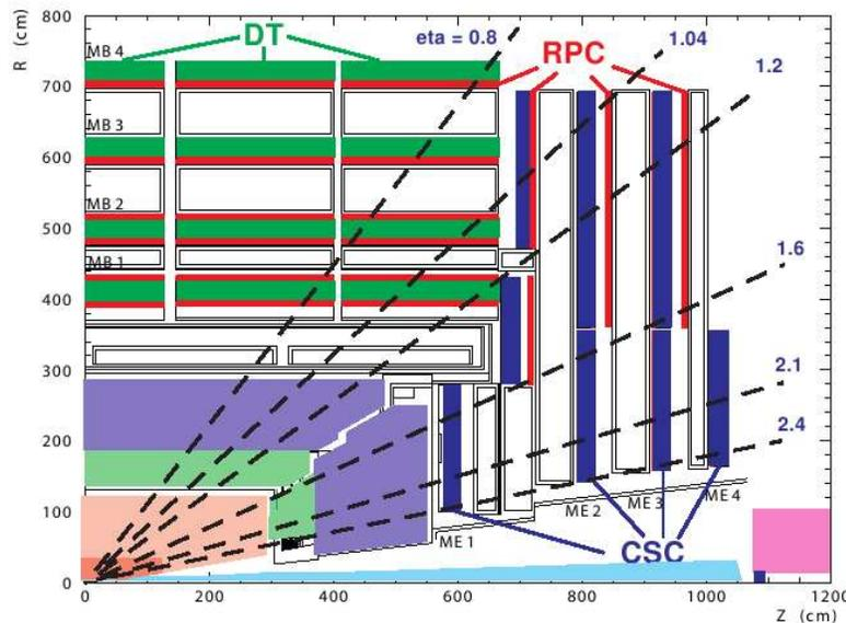
Figura 3.11: Um quarto da seção transversal do detector de múons. Os valores nas linhas tracejadas correspondem à separação em pseudo-rapidez. No eixo- $x$  (eixo- $z$  no sistema de coordenadas do CMS, vide figura 3.3, o comprimento em centímetros e no eixo- $y$ , o raio (em cm).
