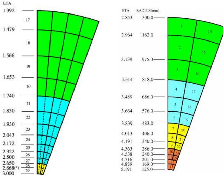
Figura 3.10: Visão de  $20^\circ$  em  $\eta - \phi$  das tampas do calorímetro hadrônico (HE) (esquerda) e do calorímetro hadrônico *forward* (HF) (direita). Os valores correspondem à separação em pseudo-rapidez.
