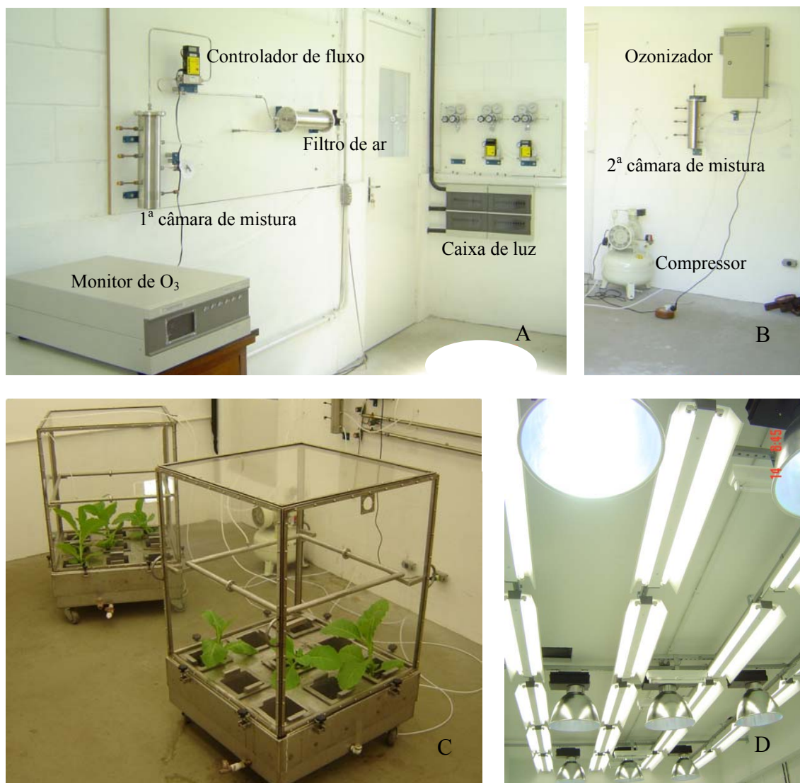
Figura 3.1: Fotos do sistema de fumigação: equipamentos (A e B), câmaras (C) e lâmpadas (D).
