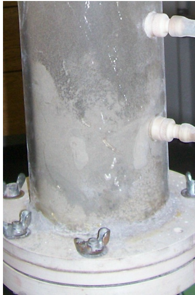
Figura 4.18: Aglomerados formados na fluidização de R. fosfática.
