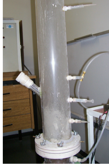
Figura 4.22: Arraste de partículas de R. fosfática.
