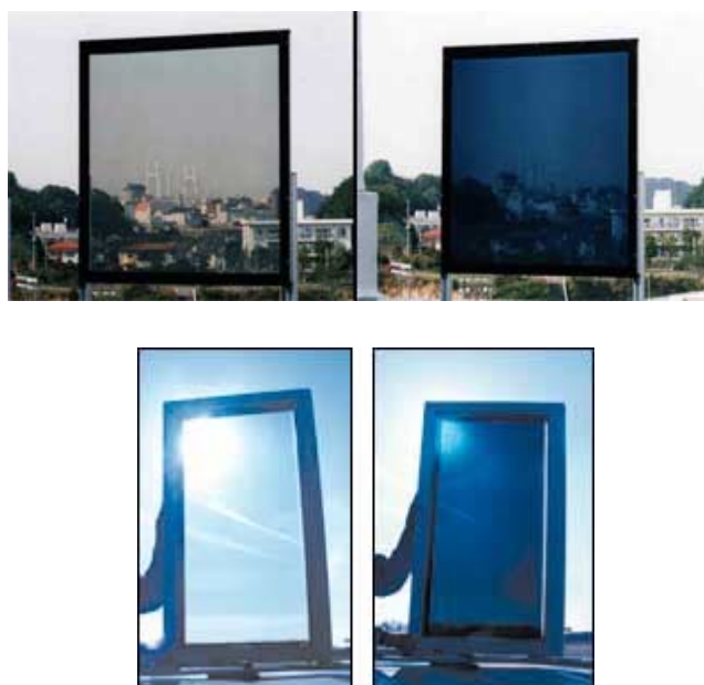
Figura 8: Exemplos de janelas eletrocromicas que mudam o contraste óptico de acordo com o potencial aplicado.
