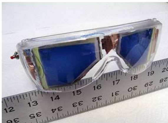
Figura 7. Protótipo de óculos composto de materiais eletrocromicos.
