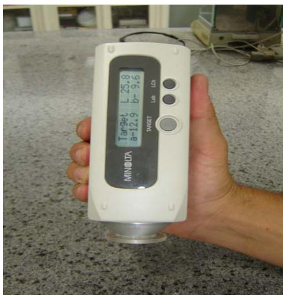
**Figura 4.** Aparelho de colorimetria MINOLTA Color reader CR10, do Centro de Ecofisiologia e Biofísica - Instituto Agrônomo de Campinas – (IAC)
