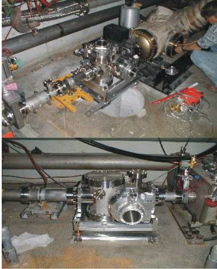
Figura 5.2: Visão frontal e lateral de um par de Roman Pots mostrando suas dimensões assim como a acomodação dos detectores, localizados na caixa de 2 cm.
