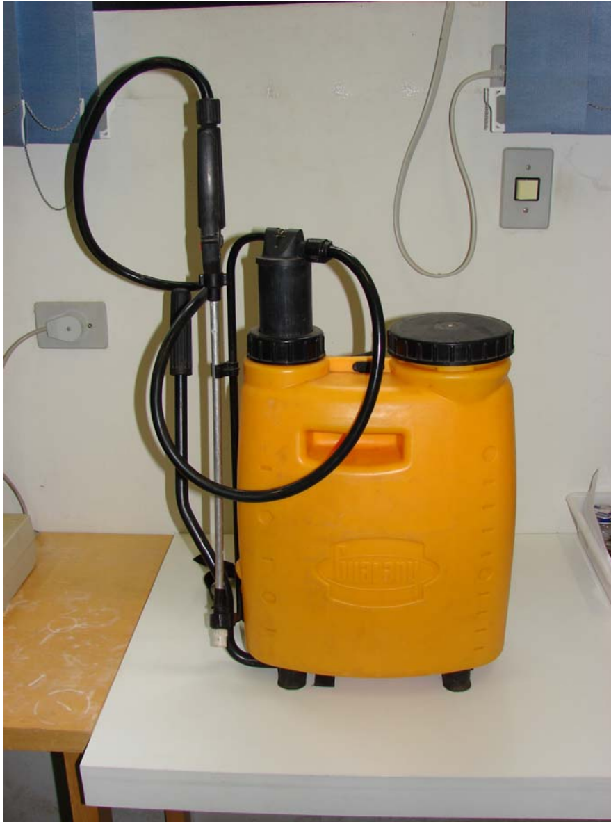
Figura 1. Pulverizador dorsal de alavanca com capacidade de 10 litros.
