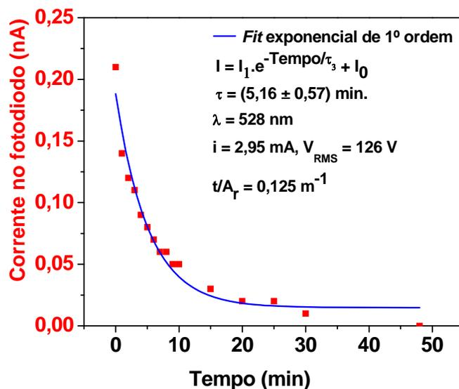
**Figura 4.4.2.3** – Corrente contra o tempo para o dispositivo formado por P(VDF-TrFE)/ZnS:Ag/ P(VDF-TrFE).
