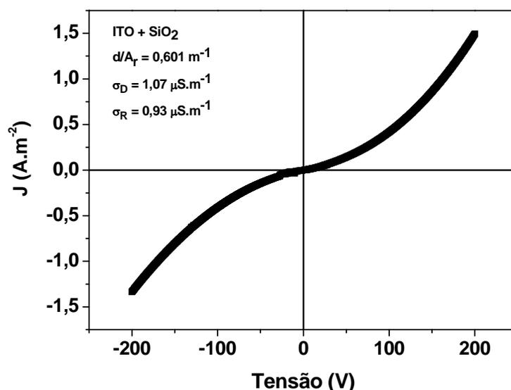
**Figura 4.3.2.9** – JxV para o dispositivo formado por POMA/P(VDF-TrFE)/Zn<sub>2</sub>SiO<sub>4</sub>:Mn sobre substrato de ITO recoberto com SiO<sub>2</sub>.
