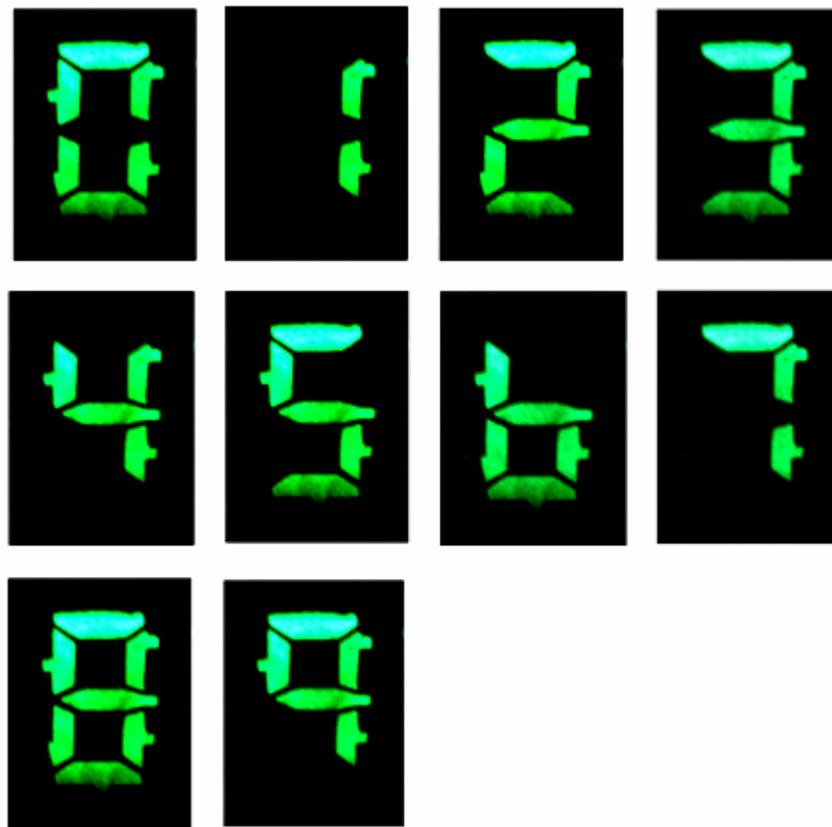
**Figura 4.5.1** – Mostrador de sete-segmentos em operação, controlado pelo *driver*.
