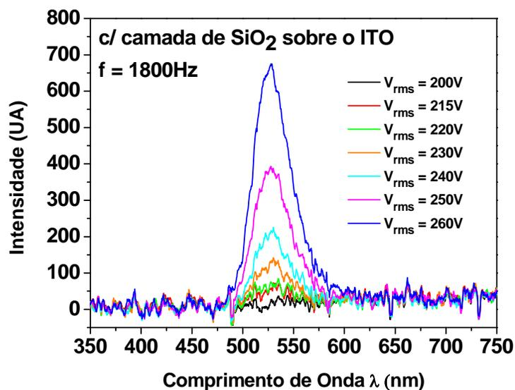
**Figura 4.3.2.12** – Espectro de emissão em função do potencial aplicado, com frequência constante. Dispositivo feito de POMA/P(VDF-TrFE)/Zn<sub>2</sub>SiO<sub>4</sub>:Mn, com uma camada de SiO<sub>2</sub> sobre o ITO.
