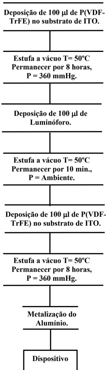
**Figura 3.2.5** – Processo de produção do dispositivo “sanduíche” de P(VDF-TrFE) e luminóforo.
