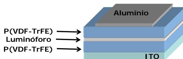
**Figura 3.2.4** – Ilustração do dispositivo feito de P(VDF-TrFE)/Luminóforo/P(VDF-TrFE).
