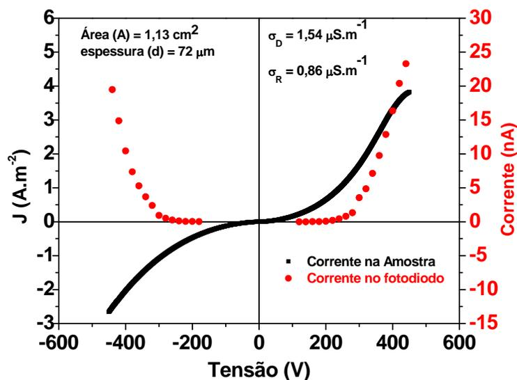
Figura 4.3.2.1 – JxV do dispositivo formado por POMA/P(VDF-TrFE)/Zn<sub>2</sub>SiO<sub>4</sub>:Mn.
