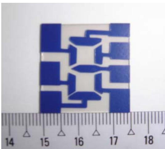
**Figura 3.3.1** – Fita adesiva sobre o ITO, utilizada no processo de corrosão do mesmo.
