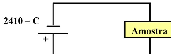
**Figura 3.5.1** – Esquema do circuito elétrico utilizado nas medidas elétricas DC.
