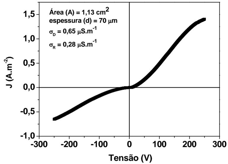
**Figura 4.3.6.1** – JxV do dispositivo formado por POMA/P(VDF-TrFE)/Y<sub>2</sub>SiO<sub>5</sub>:Ce.
