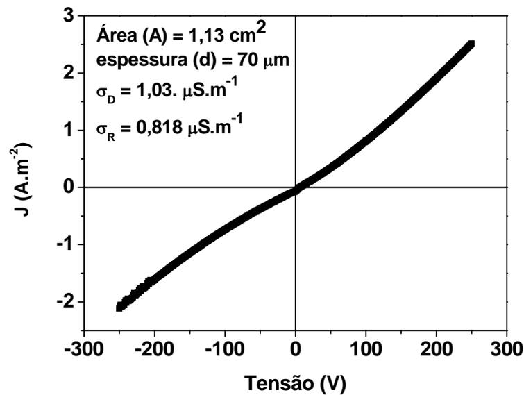
**Figura 4.3.3.1** –  $J \times V$  do dispositivo formado por POMA/P(VDF-TrFE)/ZnAl<sub>2</sub>O<sub>4</sub>:Tb.
