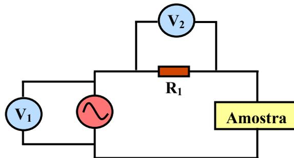
**Figura 3.5.2** – Esquema do circuito elétrico utilizado nas medidas elétricas AC.
