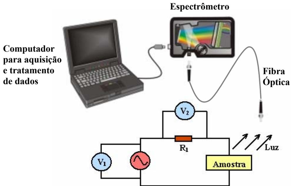
**Figura 3.5.6** – Ilustração do arranjo experimental para a aquisição do espectro luminoso das amostras que operam em AC.
