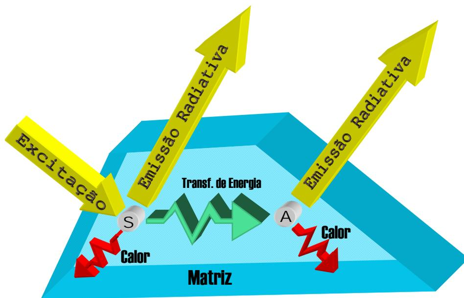
**Figura 2.5.2.** Ilustração de um material luminescente do tipo M:SA.
