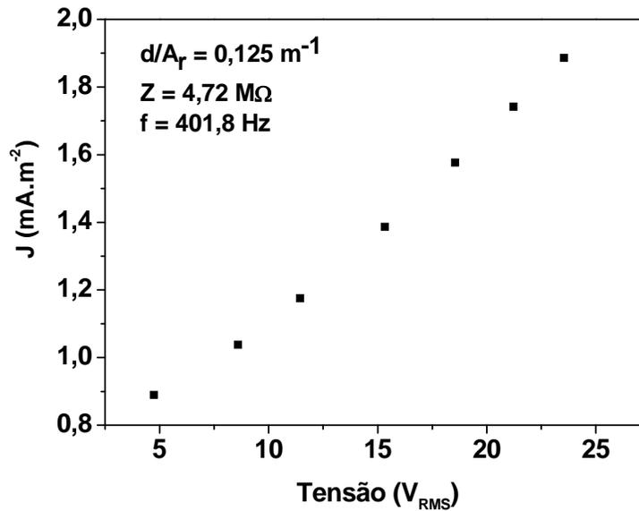
**Figura 4.4.1.2** – JxV do dispositivo formado por P(VDF-TrFE)/Zn<sub>2</sub>SiO<sub>4</sub>:Mn/P(VDF-TrFE).
