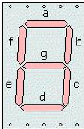
**Figura 3.4.3 – Segmentos do mostrador (a, b, c, d, e, f, g) no substrato de ITO.**
