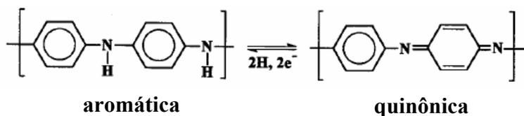
**Figura 2.3.3** – Reação de oxi-redução da PANI.
