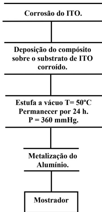
**Figura 3.3.3** – Processo de construção do mostrador.
