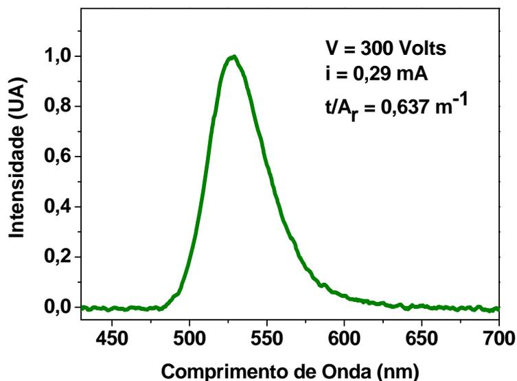
**Figura 4.3.2.4** – Intensidade de emissão vs. Comprimento de onda, do dispositivo formado por POMA/P(VDF-TrFE)/Zn<sub>2</sub>SiO<sub>4</sub>:Mn.
