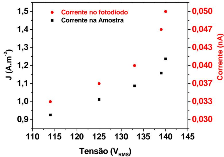
**Figura 4.4.2.2** – JxV e da intensidade vs. Tensão, do dispositivo formado por P(VDF-TrFE)/ZnS:Ag/ P(VDF-TrFE).
