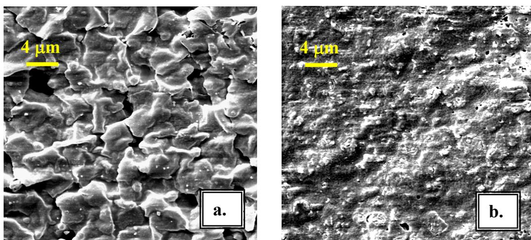
**Figura 4.2.1** – Micrografia do composto, POMA/P(VDF-TrFE)/Zn<sub>2</sub>SiO<sub>4</sub>:Mn, formador do mostrador de sete-segmentos. **a.** Superfície superior do filme. **b.** Superfície inferior, que fica em contato com o ITO.
