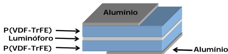
**Figura 3.2.6** – Ilustração do dispositivo flexível feito de P(VDF-TrFE)/Luminóforo/P(VDF-TrFE).
