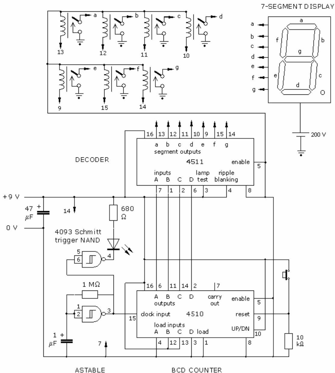
**Figura 3.4.4** – Esquema do circuito elétrico utilizado como *driver*.
