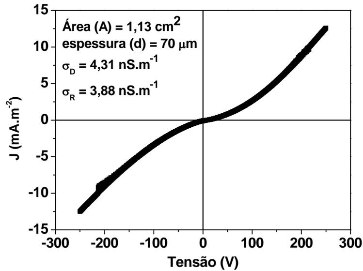
**Figura 4.3.5.1** – JxV do dispositivo formado por POMA/P(VDF-TrFE)/ZnAl<sub>2</sub>O<sub>4</sub>:Eu.
