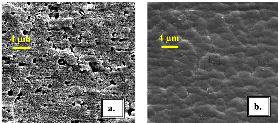
**Figura 4.2.3** – Filme de P(VDF-TrFE)/Zn<sub>2</sub>SiO<sub>4</sub>:Mn/P(VDF-TrFE). **a.** Superfície por onde ocorre a evaporação do solvente. **b.** Superfície de contato com o ITO. Aumento de 3000x.
