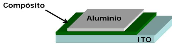
**Figura 3.2.2** – Esquema do dispositivo, após a cristalinização do compósito sobre o substrato de ITO e ulterior evaporação de alumínio.
