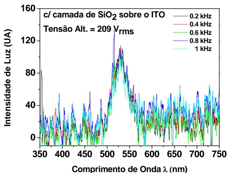
**Figura 4.3.2.11** – Espectro de emissão em função da frequência de operação.
