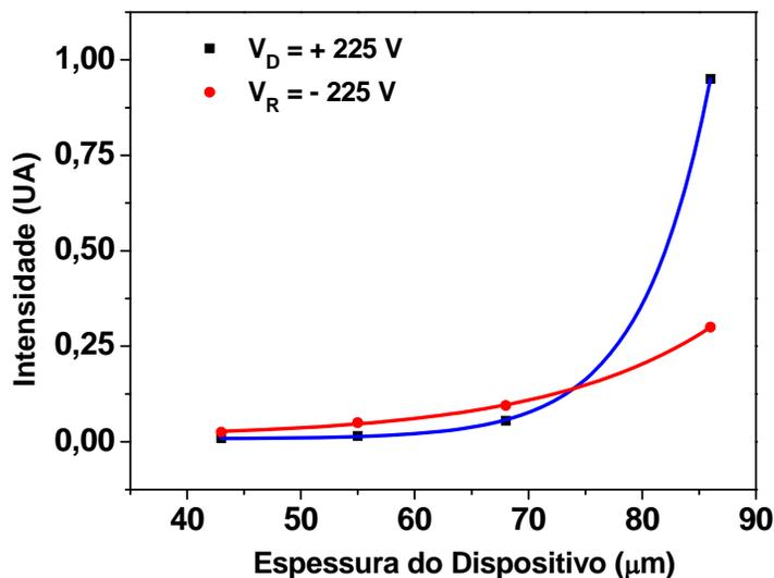
**Figura 4.3.2.7** – Intensidade luminosa contra a espessura do dispositivo.
