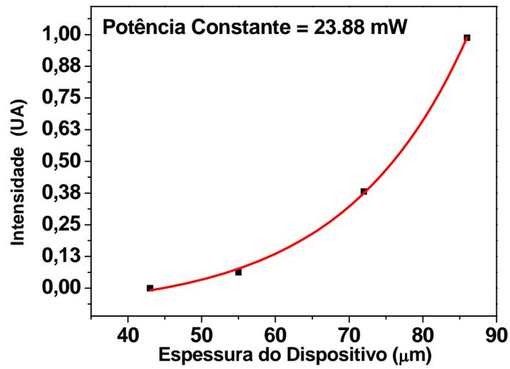
**Figura 4.3.2.8** – Intensidade luminosa vs. espessura do dispositivo, para potência elétrica constante de 23,88 mW.
