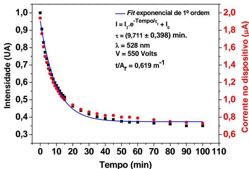
**Figura 4.3.2.5** – Corrente e Intensidade de emissão luminosa contra o tempo, para o dispositivo formado por POMA/P(VDF-TrFE)70/30/Zn<sub>2</sub>SiO<sub>4</sub>:Mn.
