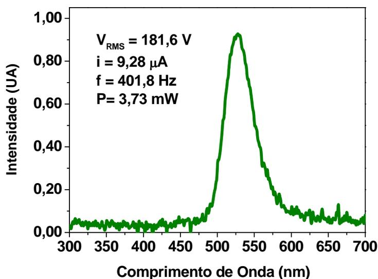
**Figura 4.4.1.1** – Intensidade vs. Comprimento de onda, do dispositivo formado por P(VDF-TrFE)/Zn<sub>2</sub>SiO<sub>4</sub>:Mn/P(VDF-TrFE).
