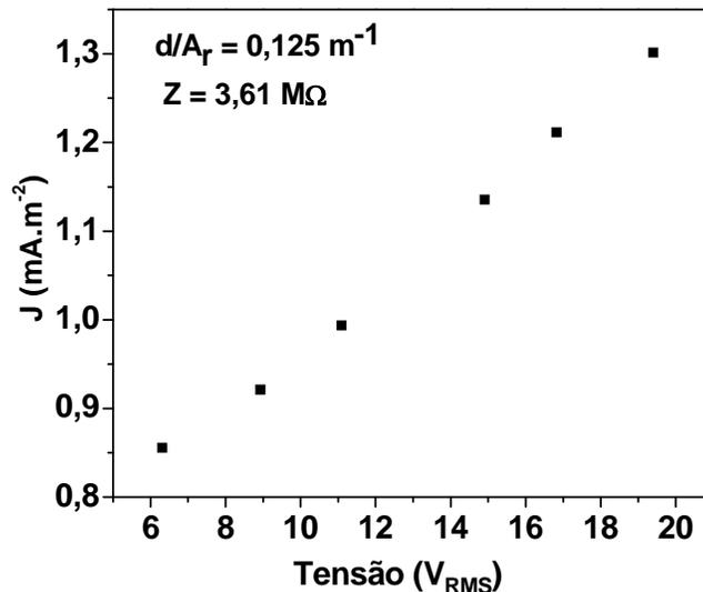
**Figura 4.4.3.1** – JxV do dispositivo formado por P(VDF-TrFE)/Y<sub>2</sub>O<sub>2</sub>S:Eu/ P(VDF-TrFE).
