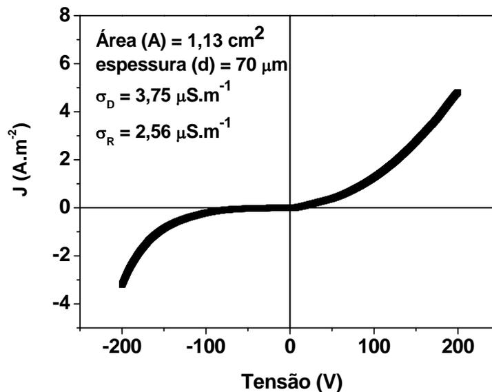
**Figura 4.3.4.1** – JxV do dispositivo formado por POMA/P(VDF-TrFE)/Y<sub>2</sub>O<sub>2</sub>S:Eu.
