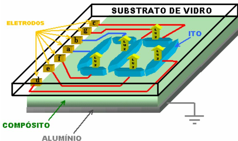
Figura 3.3.2 – Ilustração do dispositivo em uso, mostrando o número 6.
