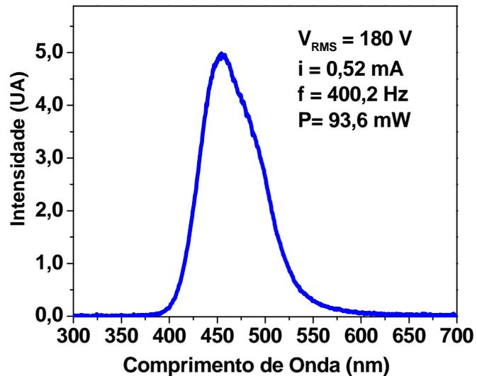
**Figura 4.4.2.1** – Intensidade vs. Comprimento de onda, do dispositivo formado por P(VDF-TrFE)/ZnS:Ag/P(VDF-TrFE).
