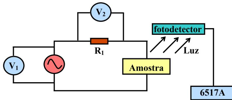
**Figura 3.5.4** – Esquema do circuito elétrico utilizado nas medidas de intensidade luminosa para tensões AC.
