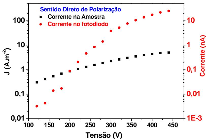
Figura 4.3.2.2 – JxV e intensidade luminosa do dispositivo formado por POMA/P(VDF-TrFE)/Zn<sub>2</sub>SiO<sub>4</sub>:Mn, para o sentido direto de polarização.
