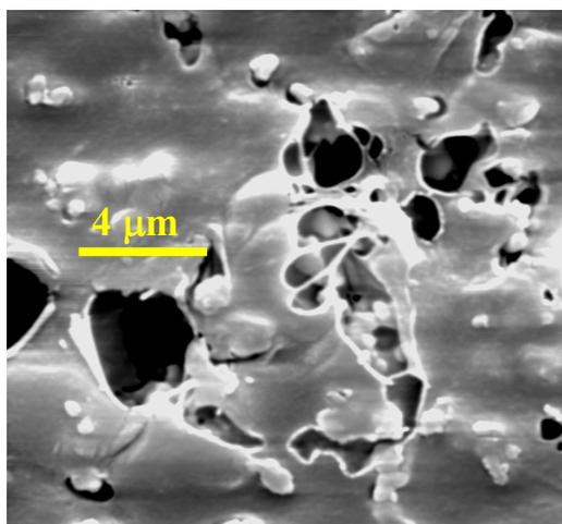
**Figura 4.2.2** – Micrografia da superfície superior da amostra, POMA/P(VDF-TrFE)/ $Zn_2SiO_4:Mn$ , face oposta a de contato com o substrato, aumento de 5000x.
