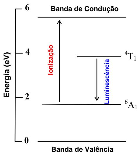
**Figura 2.5.3** – Diagrama da banda de energia do Zn<sub>2</sub>SiO<sub>4</sub>:Mn.
