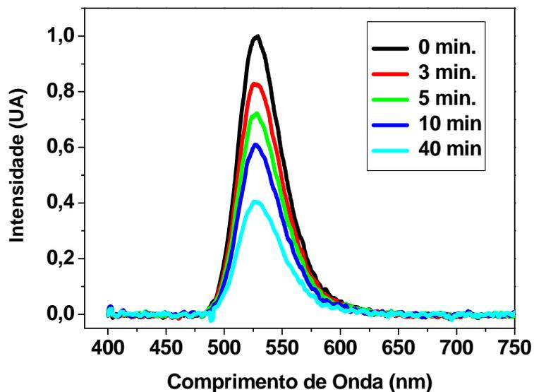
**Figura 4.3.2.6** – Espectro de emissão luminosa vs. Comprimento de onda do dispositivo formado por POMA/P(VDF-TrFE)/Zn<sub>2</sub>SiO<sub>4</sub>:Mn.
