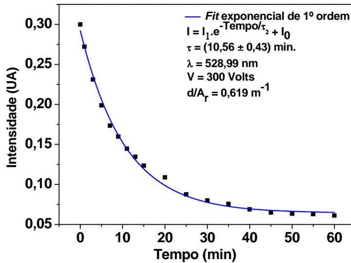
**Figura 4.3.2.10** – Intensidade luminosa vs. Tempo, do dispositivo formado por POMA/P(VDF-TrFE)/Zn<sub>2</sub>SiO<sub>4</sub>:Mn sobre o ITO recoberto de SiO<sub>2</sub>.
