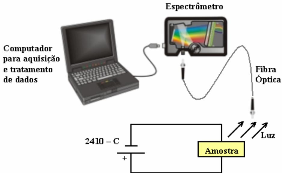
**Figura 3.5.5** – Ilustração do arranjo experimental para a aquisição do espectro luminoso das amostras que operam em DC.
