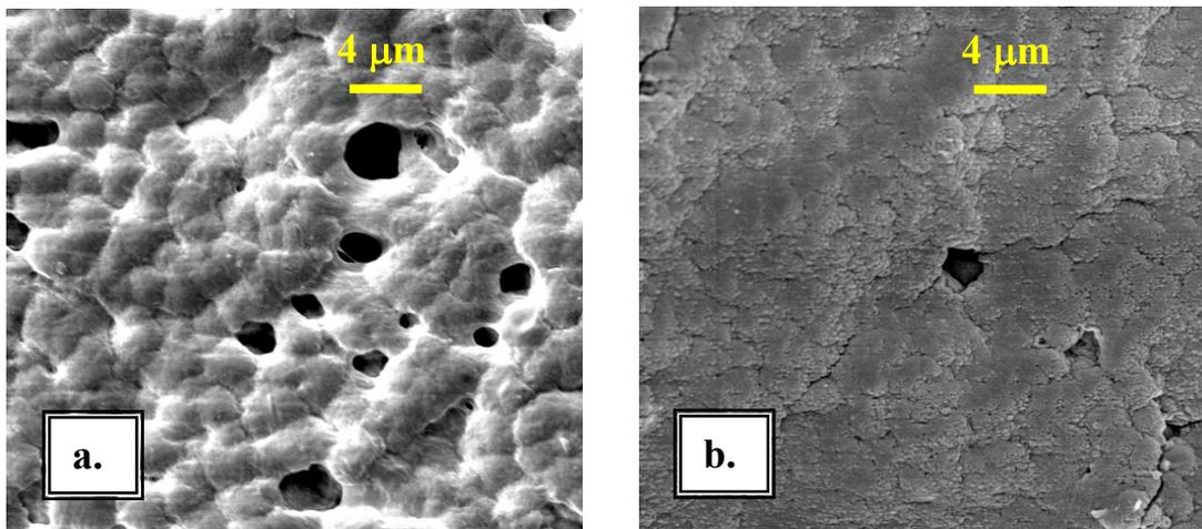
**Figura 4.2.5** – Filme de P(VDF-TrFE)/Y<sub>2</sub>O<sub>2</sub>S:Eu/P(VDF-TrFE). **a.** Superfície por onde ocorre a evaporação do solvente. **b.** Superfície de contato com o ITO. Aumento de 3000x.
