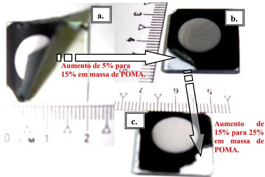
**Figura 4.1.1** – a. Filme com 5% em massa de POMA, pouco aderente ao substrato; b. Filme com 15% em massa de POMA, apresenta uma aderência significativa; c. Filme com 25% em massa de POMA, apresenta uma alta aderência.
