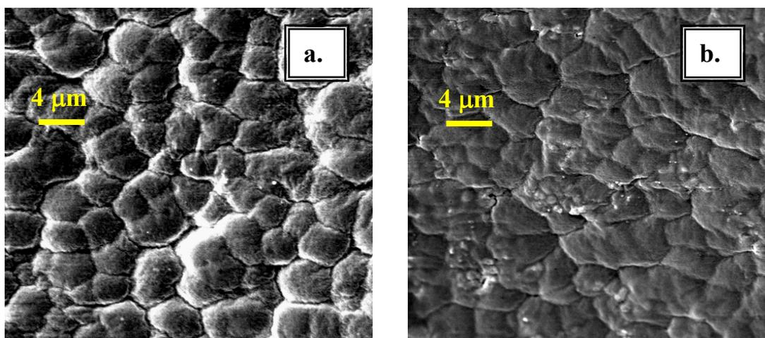
**Figura 4.2.4** – P(VDF-TrFE)/ZnS:Ag/P(VDF-TrFE). **a.** Superfície por onde ocorre a evaporação do solvente. **b.** Superfície de contato com o ITO. Aumento de 3000x.
