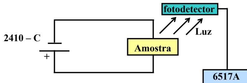
**Figura 3.5.3** – Esquema do circuito elétrico utilizado nas medidas de intensidade luminosa para tensões DC.
