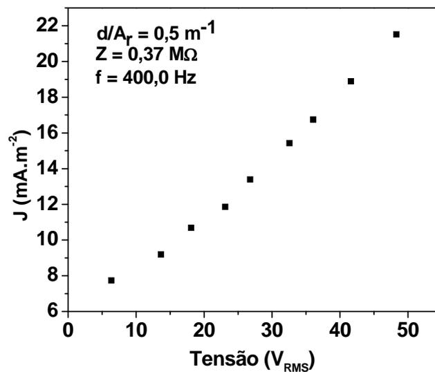
**Figura 4.4.5.1** – JxV do dispositivo formado por P(VDF-TrFE)/ZnS:Ag/P(VDF-TrFE), flexível.
