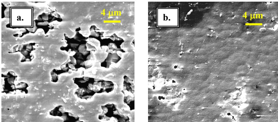
**Figura 4.2.6** – Dispositivo P(VDF-TrFE)/Y<sub>2</sub>SiO<sub>5</sub>:Ce/P(VDF-TrFE). **a.** Superfície por onde ocorre a evaporação do solvente. **b.** Superfície de contato com o ITO. Aumento de 3000x.
