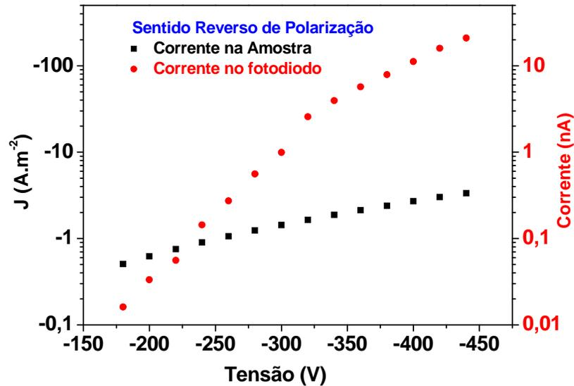
**Figura 4.3.2.3** –  $J \times V$  e intensidade luminosa medida no fotodiodo, do dispositivo formado por POMA/P(VDF-TrFE)/Zn<sub>2</sub>SiO<sub>4</sub>:Mn, para o sentido reverso de polarização.
