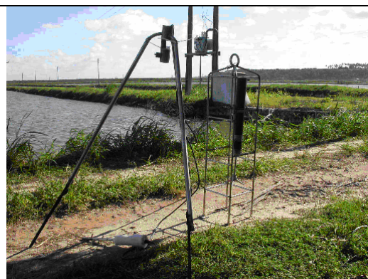
Figura 18: ADV na gaiola móvel (à direita) e ALTUS no tripé (à esquerda).
