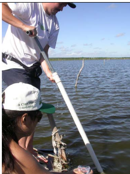
Figura 22: Amostrador de sedimentos do fundo desenvolvido pela equipe do LDSC.
