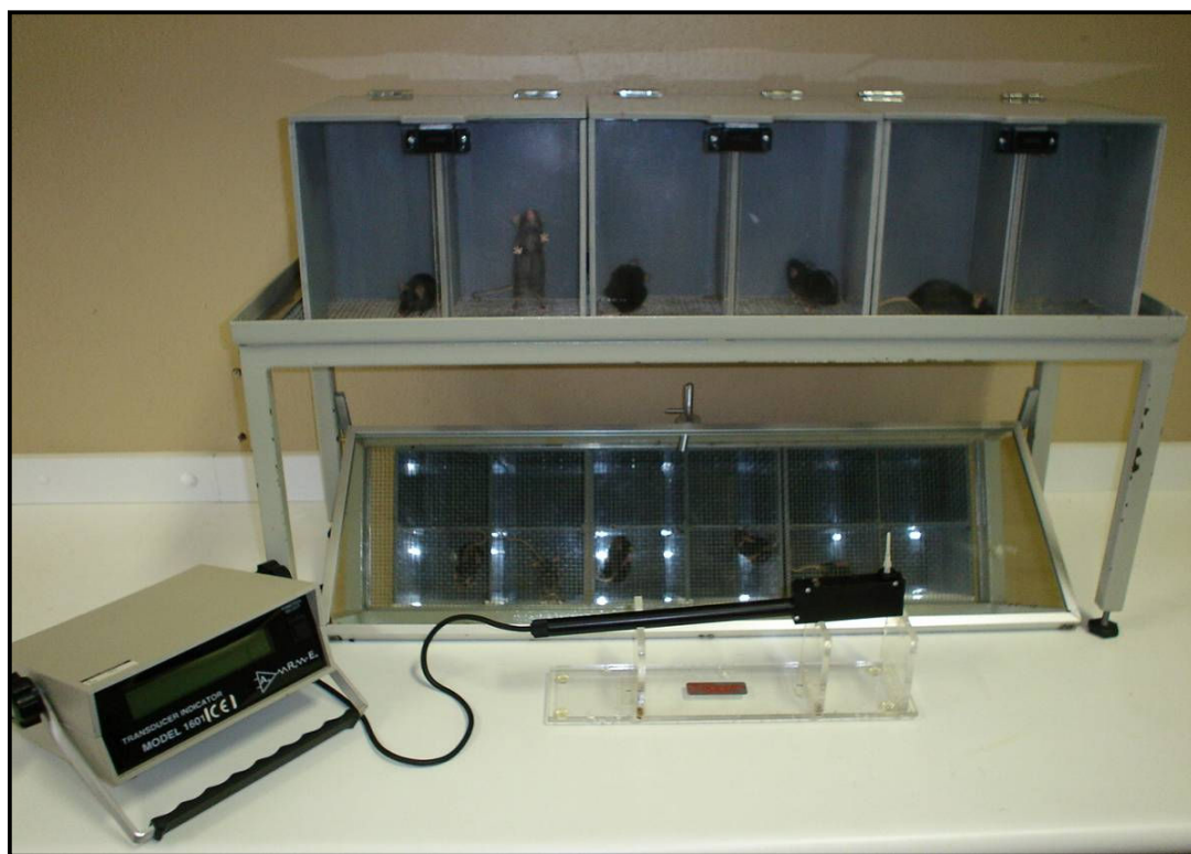
Figura 4 – Foto do equipamento utilizado no modelo de hipernociceção mecânica articular.* A foto apresenta o estesiômetro eletrônico (Modelo 1601C, Life Science Instruments Califórnia, EUA), as caixas de acrílico, o assoalho em tela reticulada de arame e o espelho, utilizados no modelo de hipernociceção mecânica articular.
