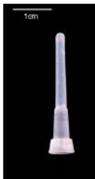
Figura 3 – Foto da ponteira utilizada no modelo de nociceção articular.* A foto apresenta a ponteira (de área – 4,15 mm 2 ) utilizada na avaliação da resposta hipernociceptiva mecânica articular.
