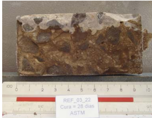
Figura 5.5 – Aspersão de solução de nitrato de prata nos corpos-de-prova após ensaio ASTM C1202/05
