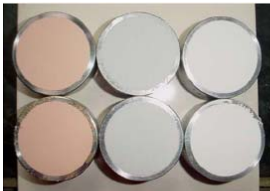
Figura 4.7 – Pastilhas de metacaulim, sílica ativa e cimento branco, respectivamente, utilizadas para leituras colorimétricas (PASSUELO, 2004)
