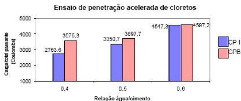
Figura 3.3. Resultados de penetração a cloretos. (Mattos & Dal Molin, 2003)
