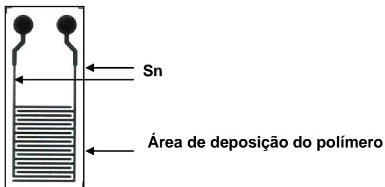
**Figura 3.9:** Eletrodo interdigitado utilizado para a confecção dos sensores.
