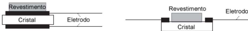
Figura 1.6<sup>9</sup>: Diagrama esquemático de sensores piezoelétricos.
