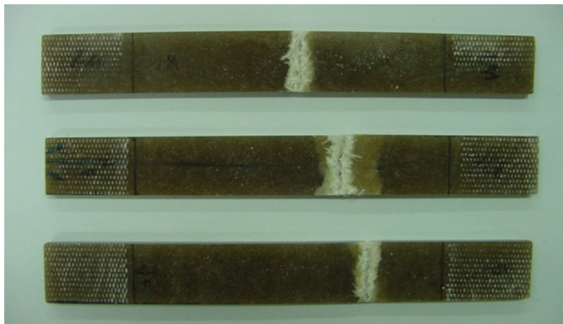
Figura 4.11 – CPs pós-ensaio do compósito CV submetidos à tração uniaxial.
