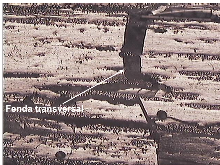
Figura 4.20 – Fenda transversal na linha neutra no CV (50x)
