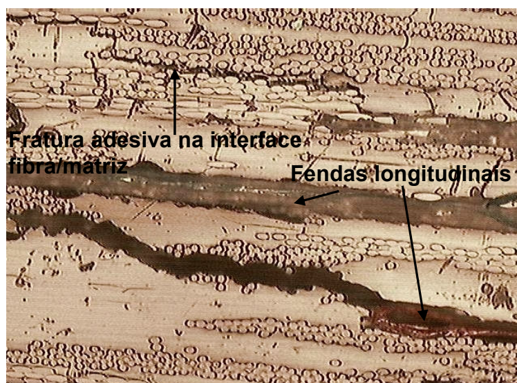
Figura 4.36 – Fenda longitudinal na segunda camada de fibras de vidro no CVE (100x)
