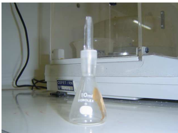
Figura 3.3 - Picnômetro – ensaio de densidade.
