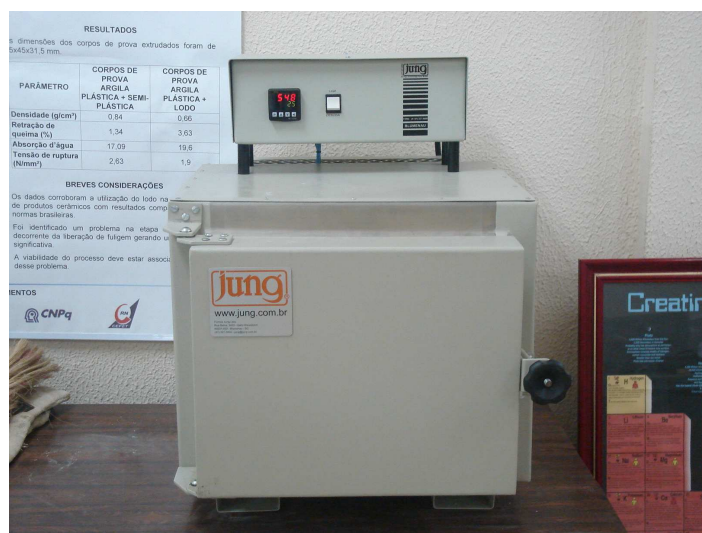
Figura 3.10 – Fotografia da mufla utilizada para a sinterização dos corpos-de-prova localizada no CEFET-RN
