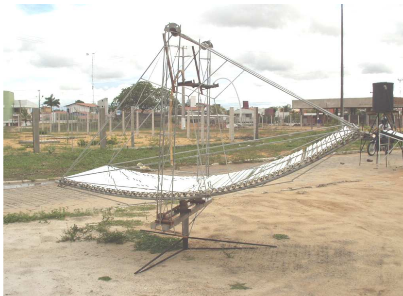
Figura 15. Concentrador cilindro-parabólico construído no LMHES-UFRN.
