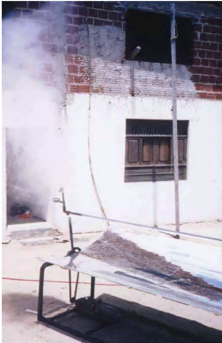
Figura 34. Concentrador cilindro-parabólico em operação
