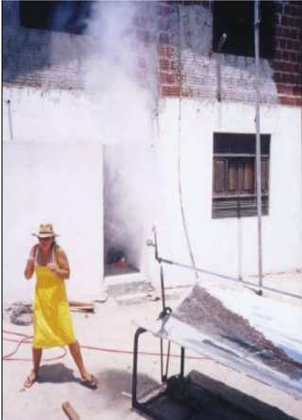
Figura 33. Concentrador cilindro-parabólico em operação.
