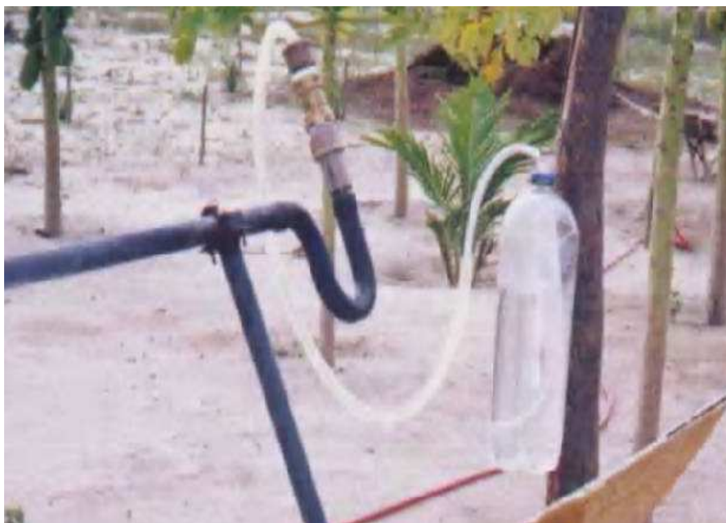
Figura 31. Detalhes do sistema de alimentação do concentrador proposto.
