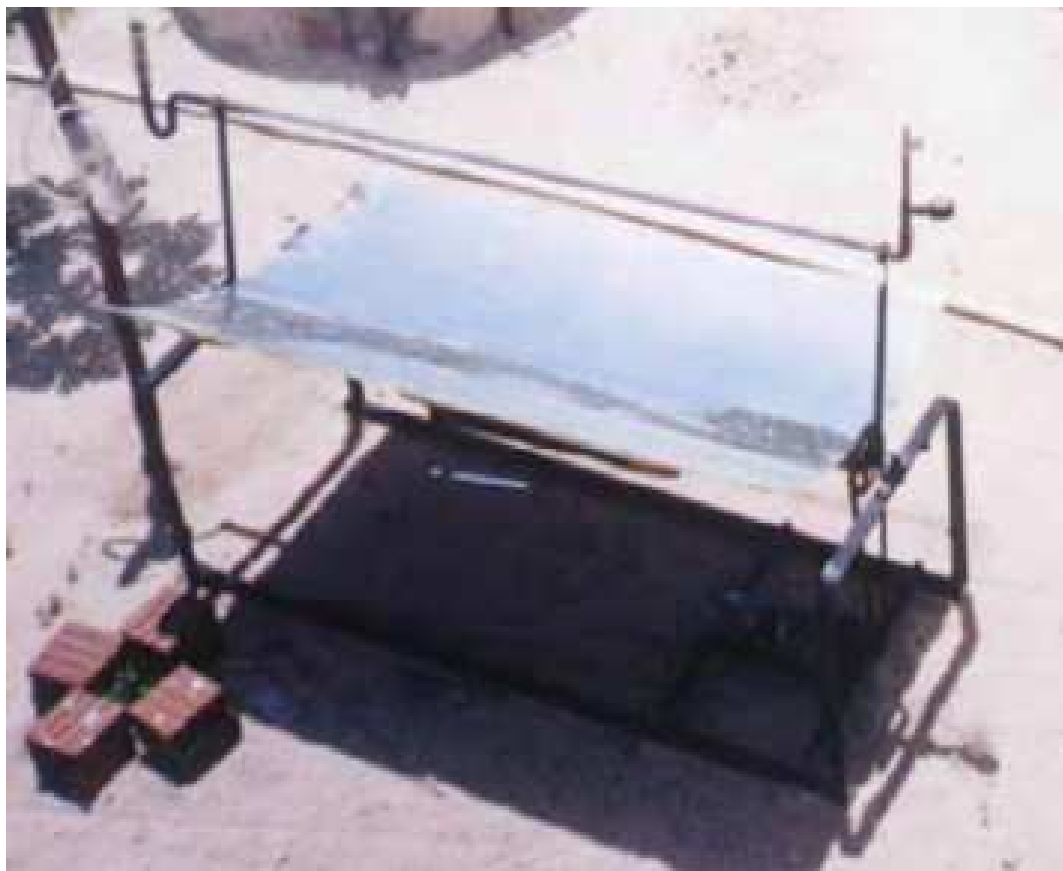
Figura 30. Concentrador cilindro-parabólico em teste.
