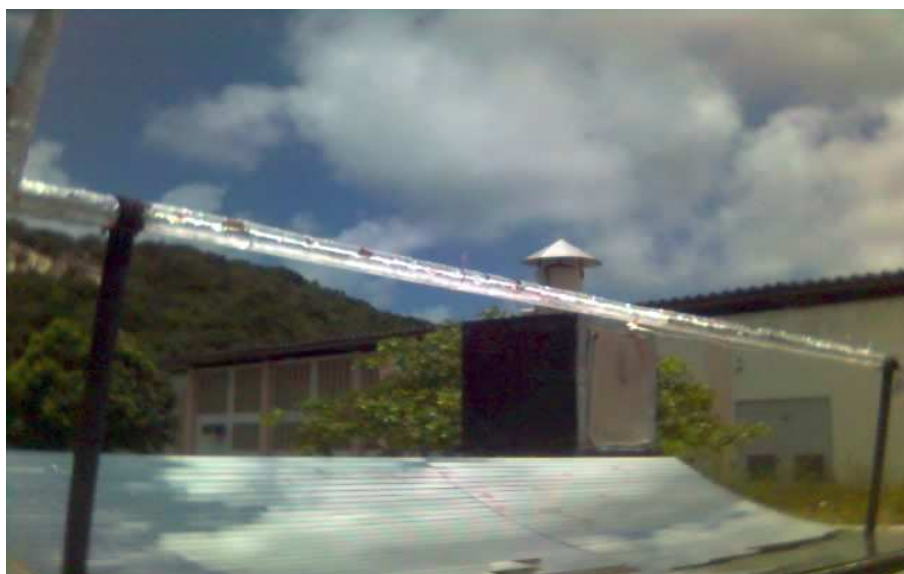
Figura 23. Tubo absorvedor do concentrador proposto.
