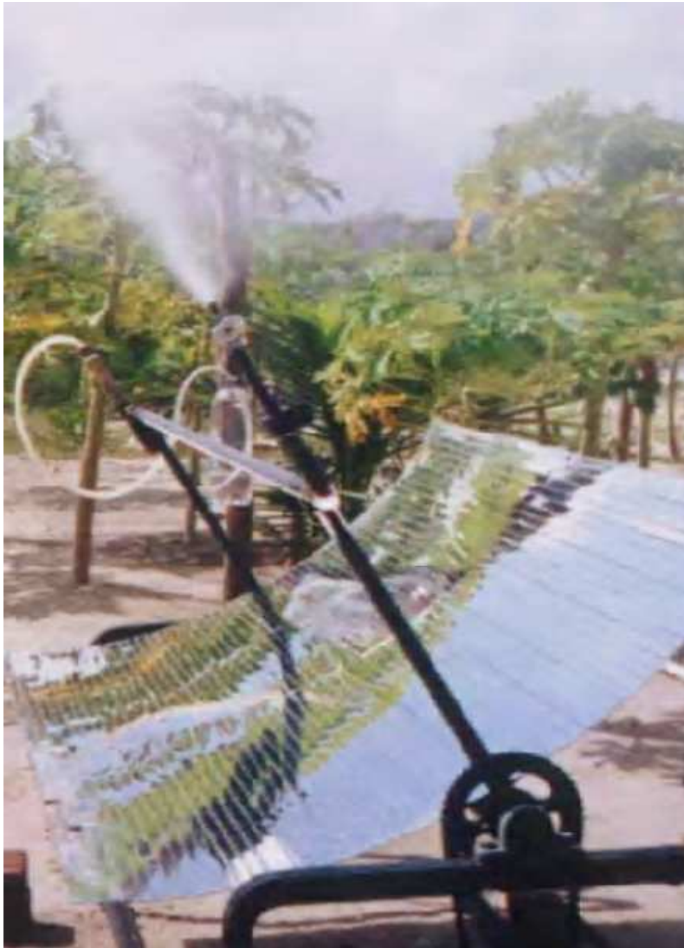
Figura 32. Concentrador cilindro-parabólico em operação
