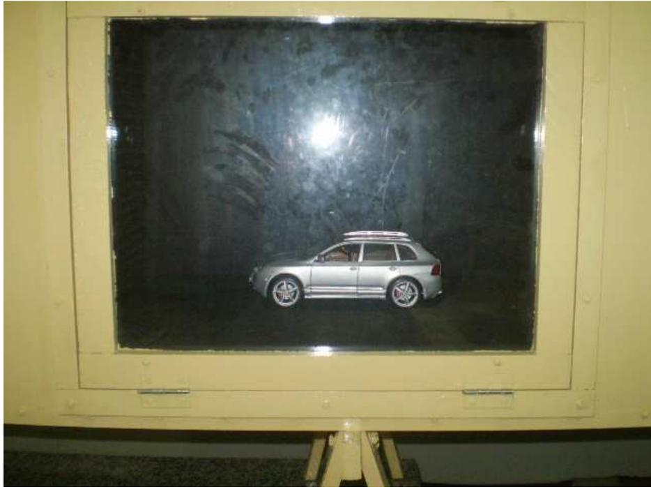
**Figura 59.** Modelo familiar em ensaio no túnel.
