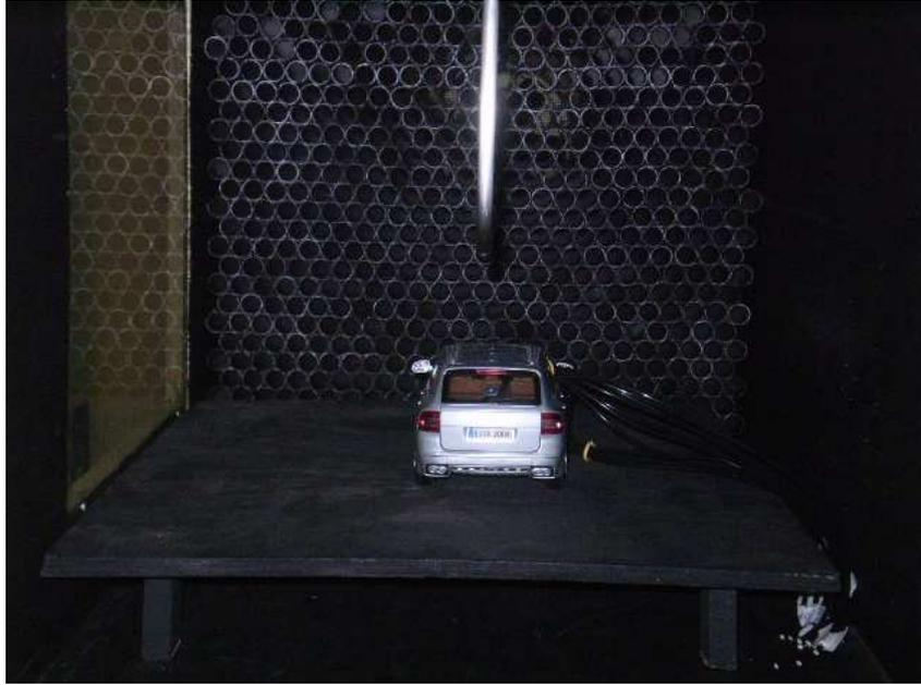
**Figura 87.** Mesa simuladora do piso instalada no túnel.
