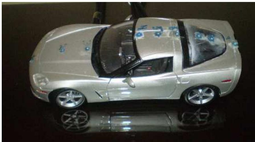
**Figura 74.** Vista das tomadas de pressão da superfície superior do modelo esportivo.
