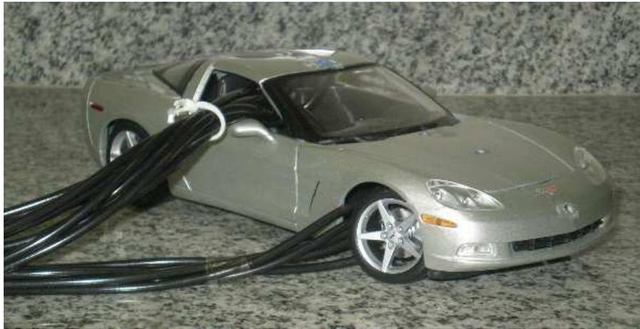
**Figura 84.** Tubo plásticos utilizados nas tomadas de pressão no modelo esportivo.
