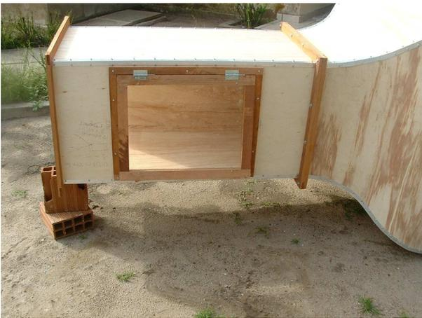
**Figura 39.** Construção da seção de ensaios.
