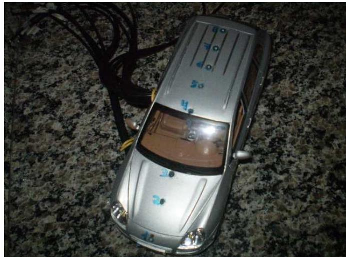
**Figura 65.** Tomadas de pressão da superfície superior do modelo familiar.
