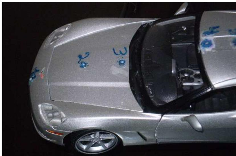
**Figura 77.** Detalhe das tomadas de pressões da dianteira do modelo esportivo.
