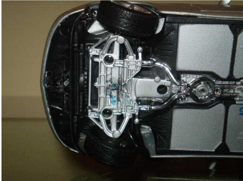
**Figura 79.** Detalhe das tomadas de pressão da parte dianteira da superfície inferior do modelo esportivo.
