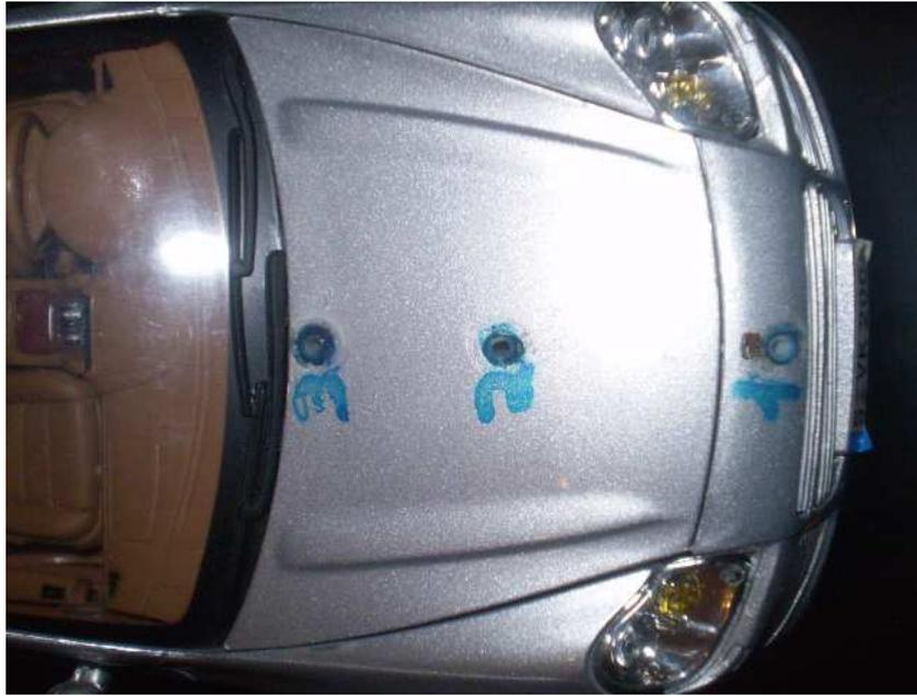
**Figura 69.** Detalhe das tomadas de pressões da dianteira do modelo familiar.
