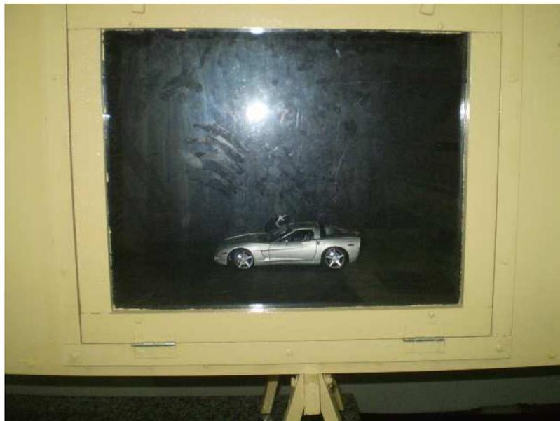
**Figura 63.** Modelo esportivo em ensaio no túnel.
