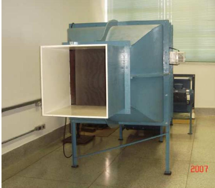
**Figura 34.** Túnel aerodinâmico com difusor.
