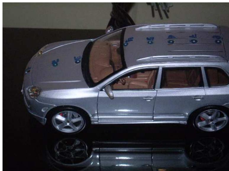
**Figura 68.** Vista das tomadas de pressão da dianteira do modelo familiar.
