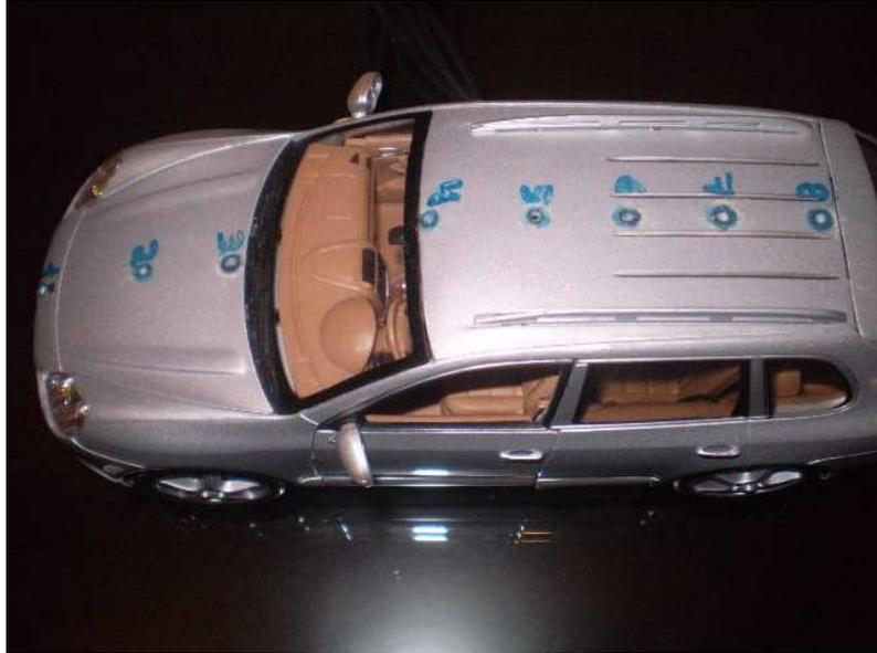
**Figura 66.** Vista das tomadas de pressão da superfície superior do modelo familiar.
