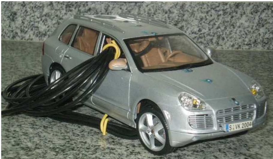
**Figura 85.** Tubo plásticos utilizados nas tomadas de pressão no modelo familiar.
