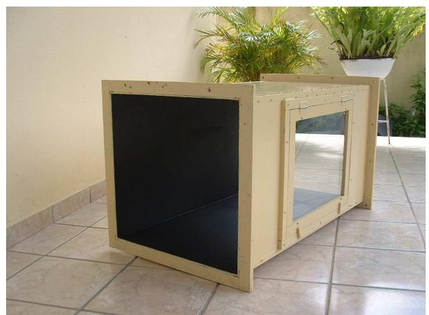
**Figura 40.** Seção de ensaios construída.
