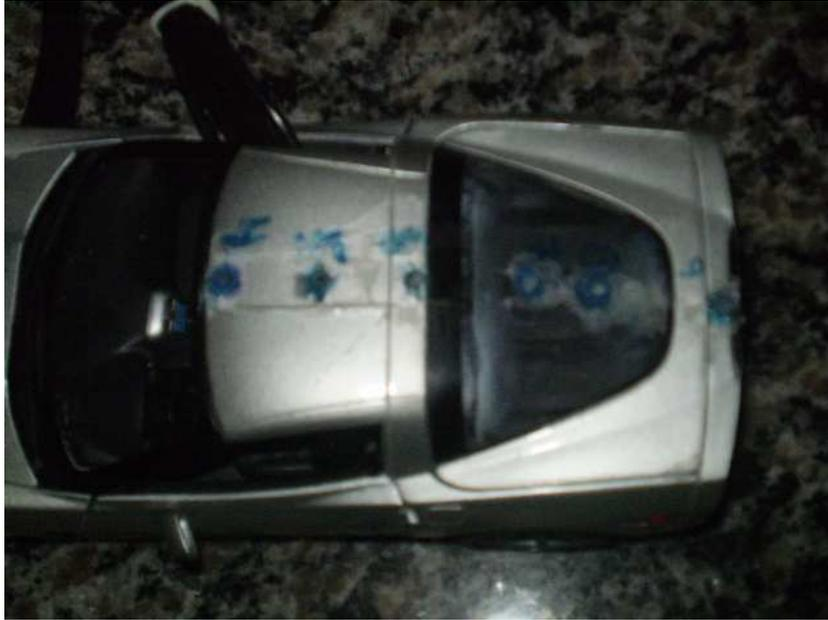
**Figura 75.** Detalhe das tomadas de pressão da superfície superior do modelo esportivo.
