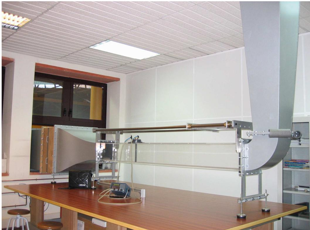
**Figura 29.** Túnel aerodinâmico do tipo circuito fechado.
