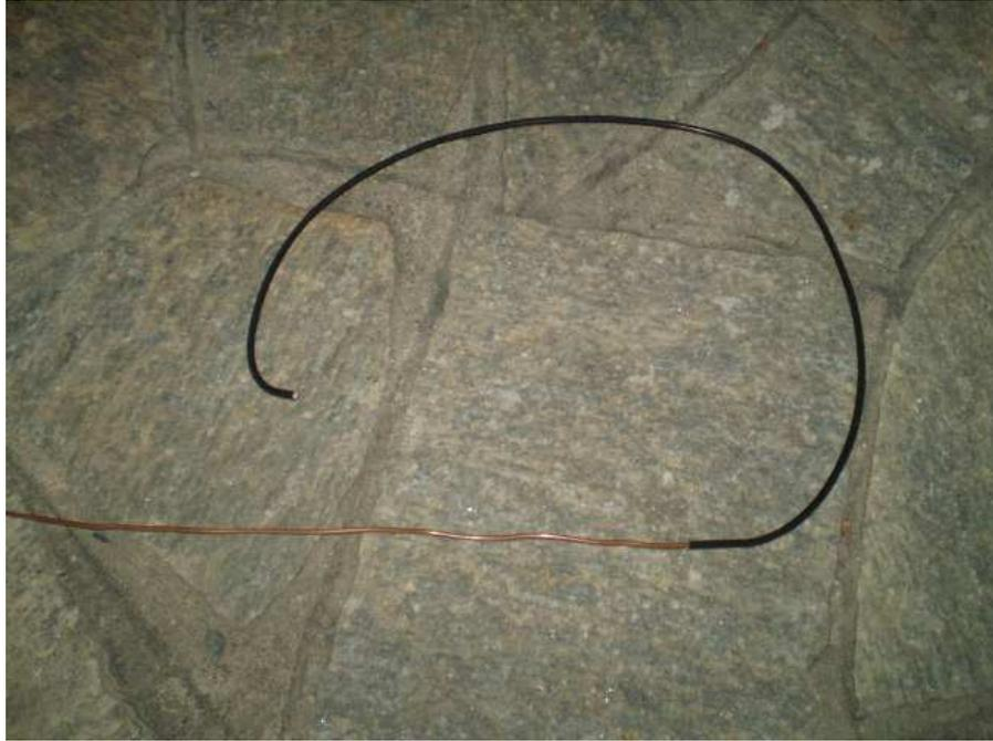
**Figura 83.** Retirada do cobre para utilização dos tubo plásticos.
