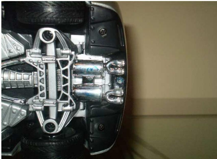
**Figura 80.** Detalhe das tomadas de pressão da parte traseira da superfície inferior do modelo esportivo.
