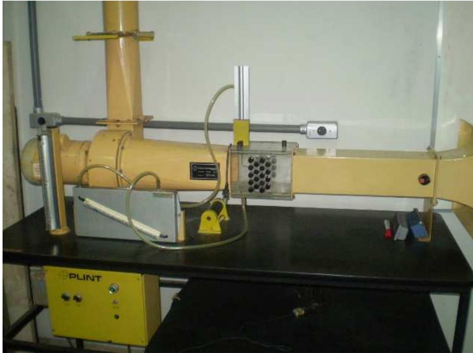
**Figura 32.** Túnel aerodinâmico do tipo exaustor com circuito aberto.
