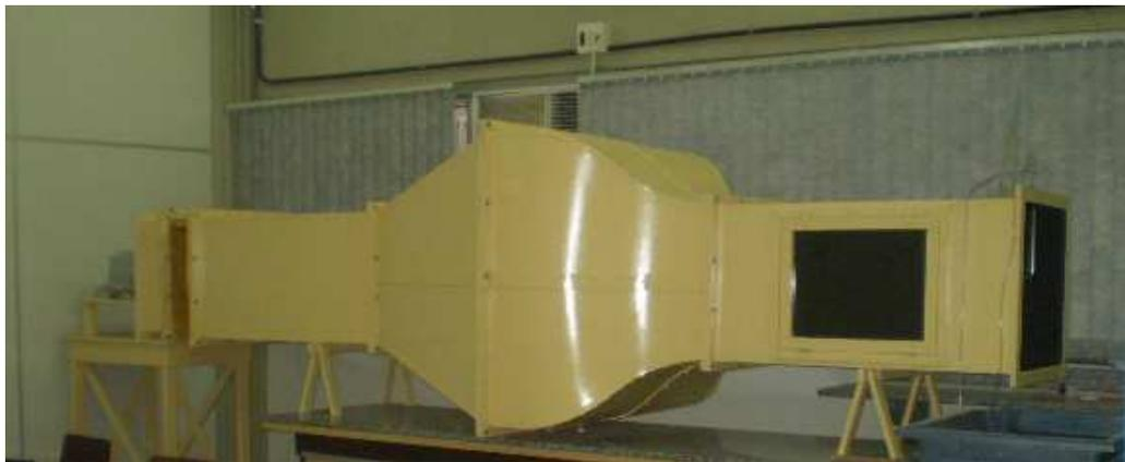
**Figura 31.** Túnel aerodinâmico do tipo soprador com circuito aberto.
