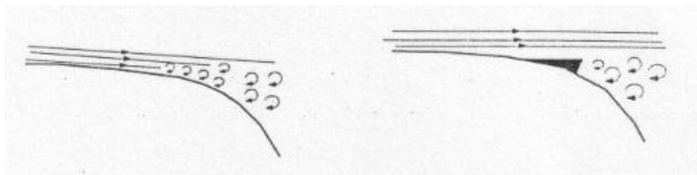
**Figura 18.** Utilização de cantos auxiliares em locais de deslocamento da camada limite (CAMPBELL, 1969).
