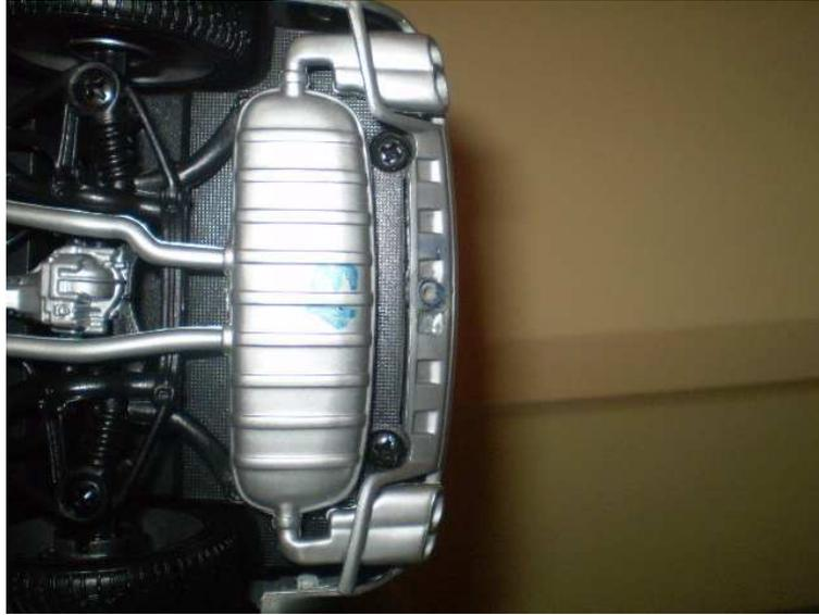
**Figura 72.** Detalhe das tomadas de pressão da parte traseira da superfície inferior do modelo familiar.
