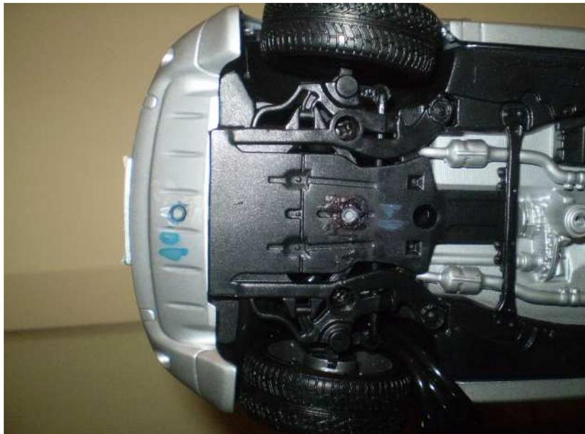
**Figura 71.** Detalhe das tomadas de pressão da parte dianteira da superfície inferior do modelo familiar.
