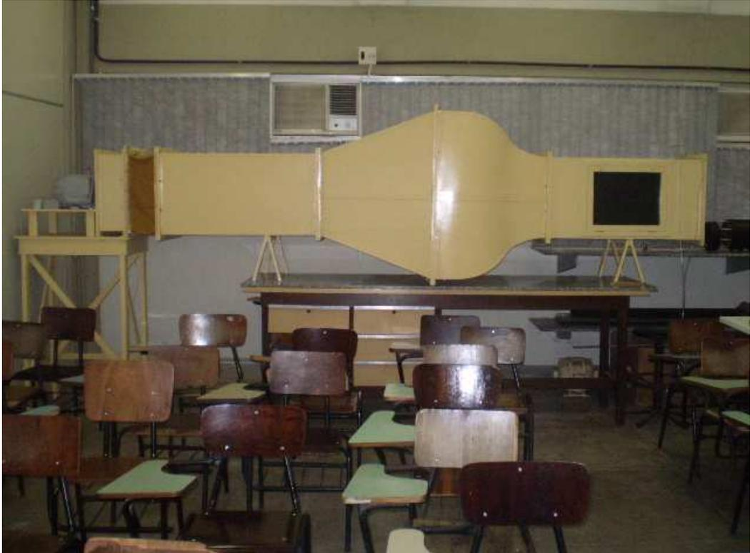
**Figura 55.** Túnel Aerodinâmico instalado.
