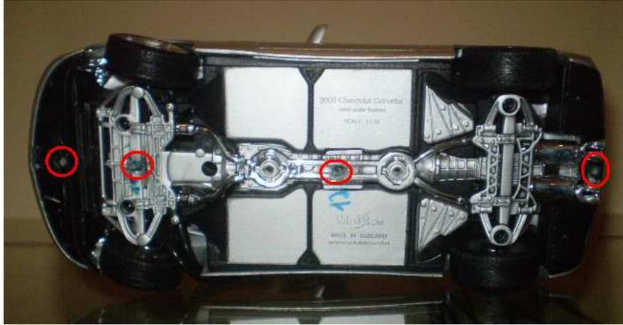
**Figura 78.** Tomadas de pressão da superfície inferior do modelo esportivo.
