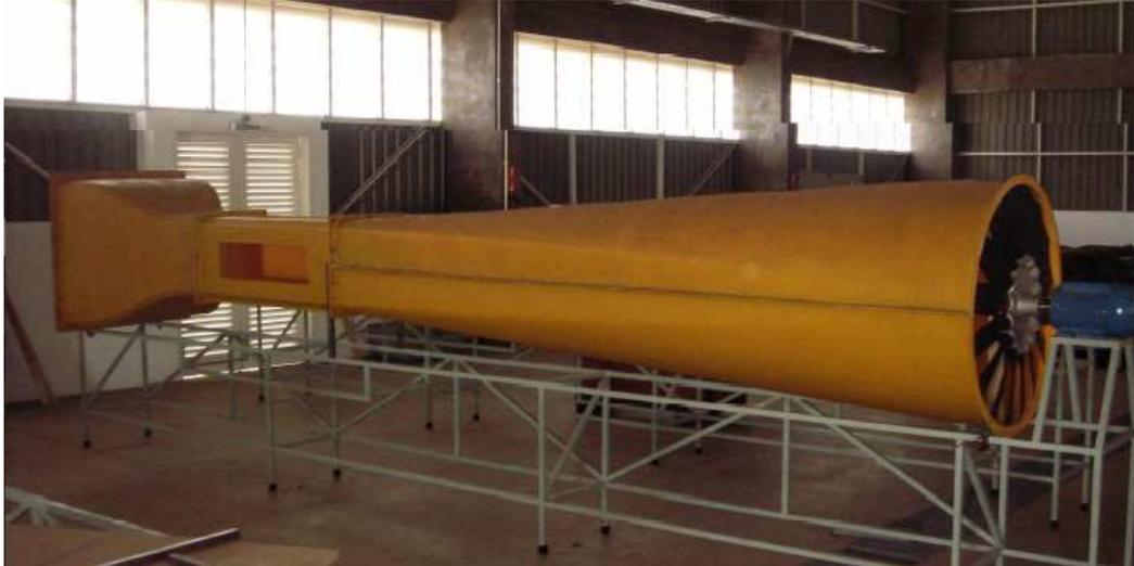
**Figura 30.** Túnel aerodinâmico do tipo circuito aberto.
