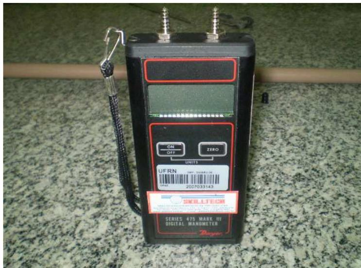
**Figura 88.** Micromanômetro digital usado no experimento.
