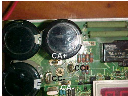
Fig. 3.3 Bornes de entrada e saída do retificador interno do inversor CFW-07 da WEG.
