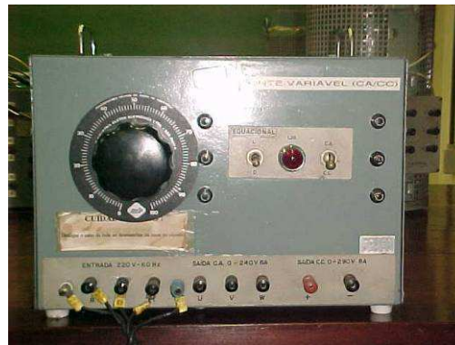
Fig. 3.5 Fonte utilizada para teste de alimentação do barramento CC.
