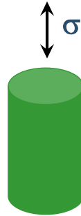
Figura 3.37 – Ensaio experimental realizado por Sinha et al. (1964): corpos-de-prova cilíndricos sob carga de compressão axial cíclica.
