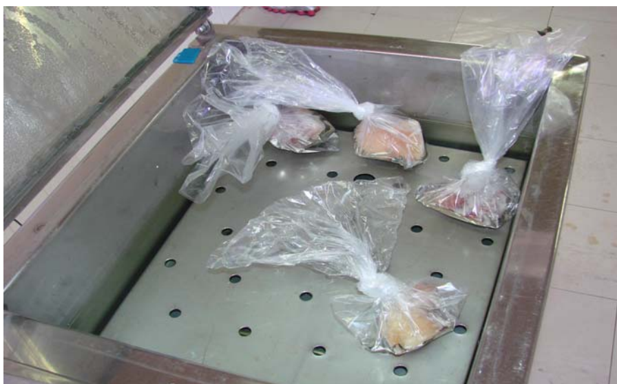
Anexo 2.2- Imagem de amostras de filé de pescado acondicionadas em sacos plásticos e dispostas dentro do banho-maria durante o procedimento da análise de perda de água por cozimento.
