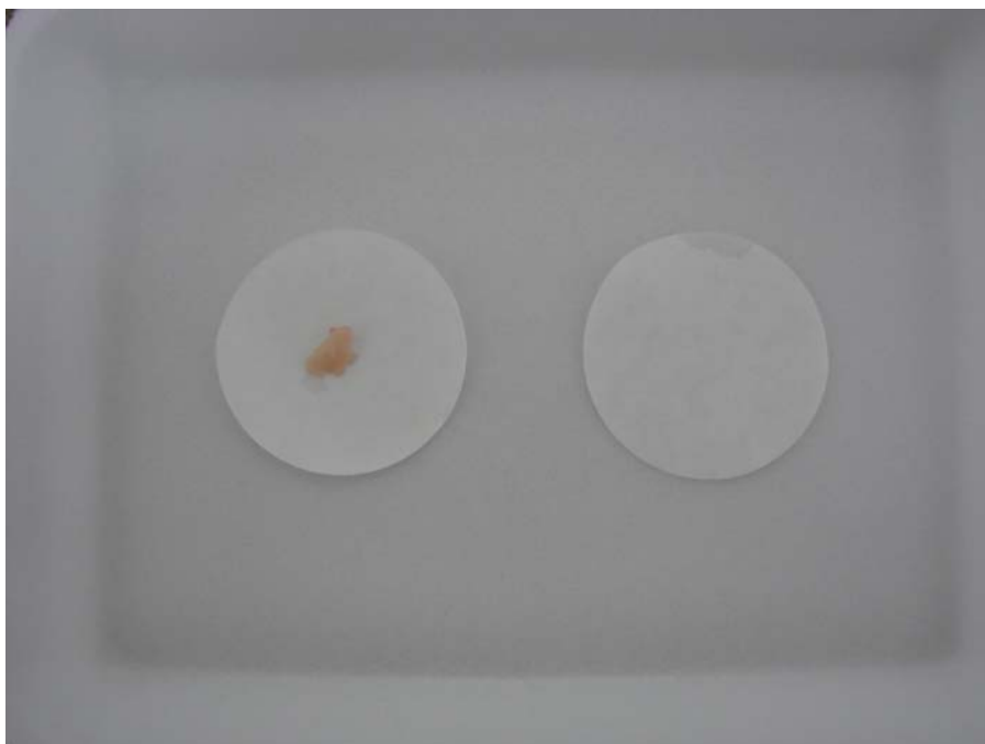
Anexo 2.4 - Amostra de filé de pescado disposta no papel filtro sobre a placa de vidro utilizada para a análise de perda de água por pressão.
