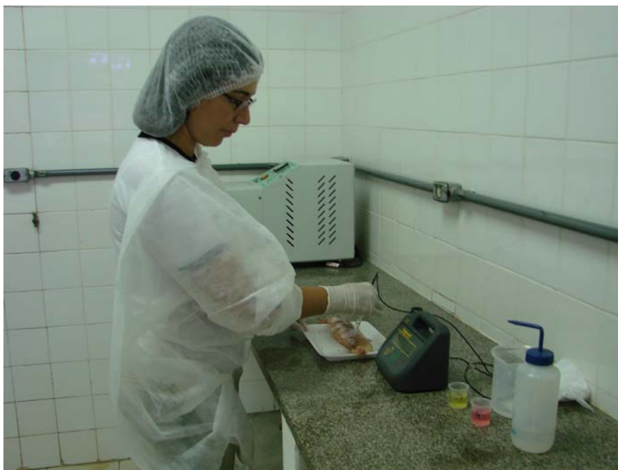
Anexo 2.1- Imagem do procedimento de aferição do pH final em filé de pescado.
