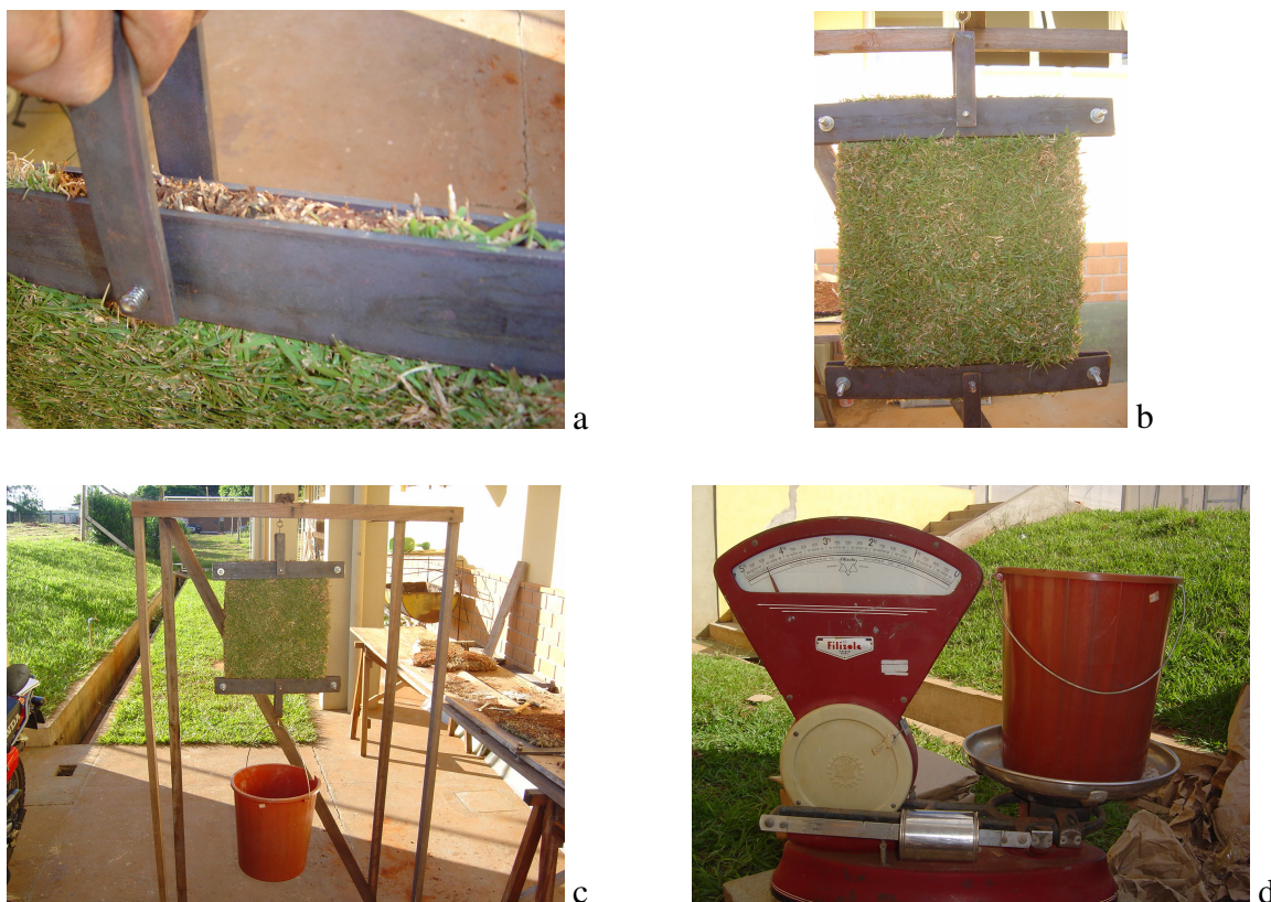
Figura 9. a – detalhe da presilha na extremidade do tapete; b – tapete preso nas duas extremidades; c – tapete pendurado para determinação da resistência; d – utilização da balança para determinação da massa necessário para o rompimento do tapete.
