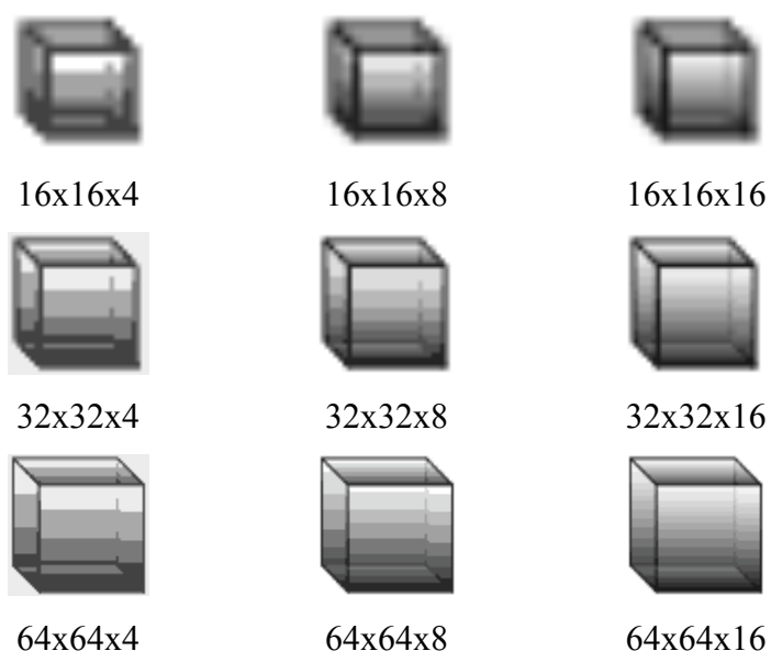
Figura 2.6 – Exemplos de uma imagem com diferentes valores de resolução e escala de cinza
