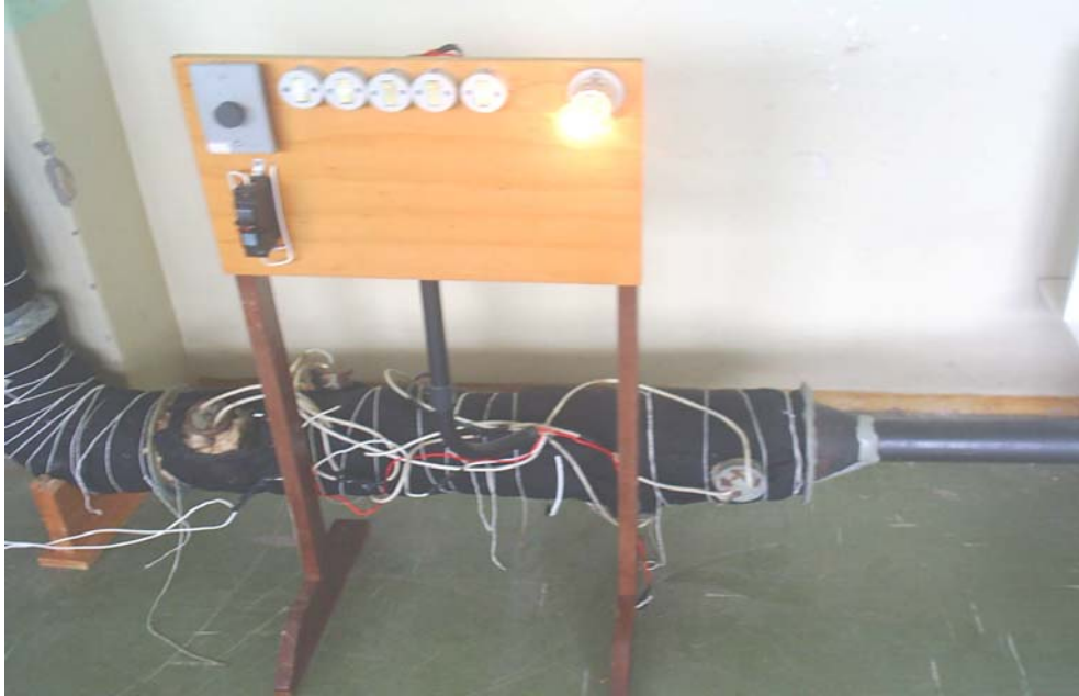
Figura 18 - Foto do painel de controle dos aquecedores e as ligações com a câmara de aquecimento.
