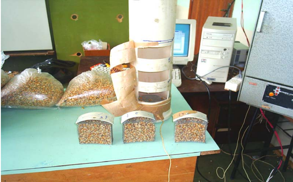
Figura 16 – Fotografia da câmara de secagem com as telas de secções de secagem e dos aparelhos utilizados para fazer as leituras e o controle do equipamento experimental.
