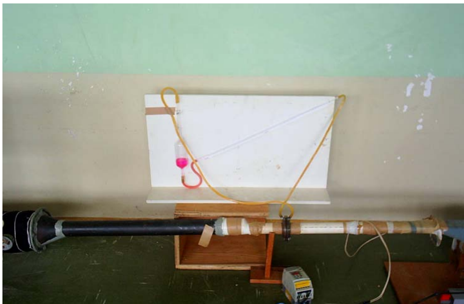
Figura 16 – Fotografia da câmara de secagem com as telas de secções de secagem e dos aparelhos utilizados para fazer as leituras e o controle do equipamento experimental.
