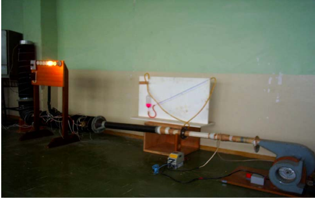
Figura 22 – Equipamento em funcionamento com a câmara de secagem em camada fina.
