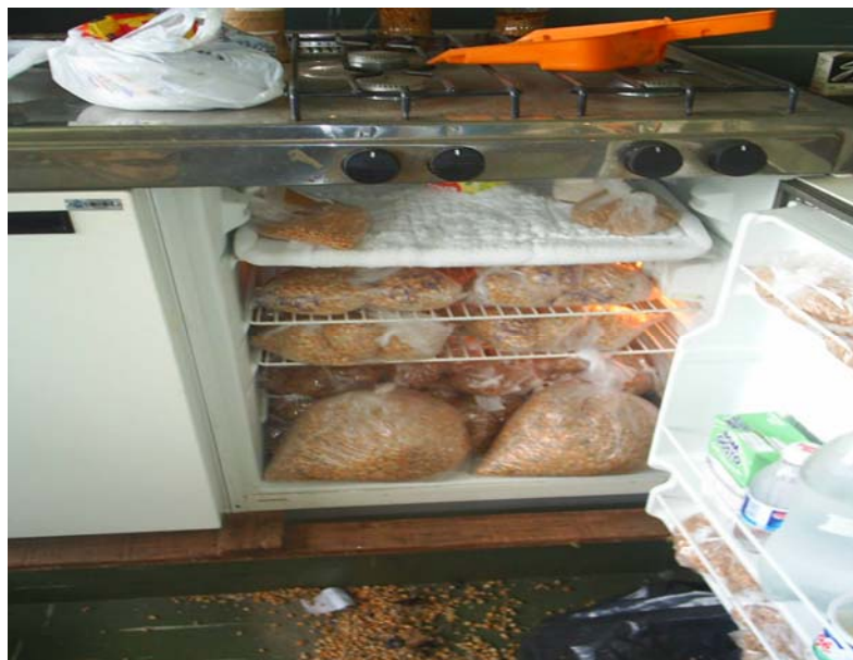
Figura 20 - Foto da geladeira com as amostras de 282 gramas e sacos de grão de milho para preencher o restante da câmara de secagem.
