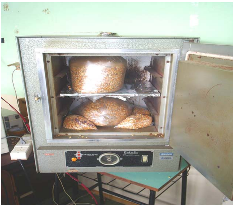
Figura 19 – Foto da estufa com as respectivas amostras de 282,16 gramas e os sacos de grãos de milhos para completar o restante da câmara de secagem.
