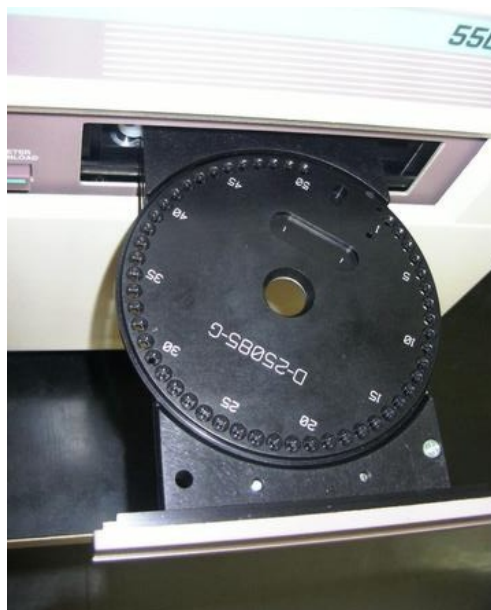
Figura 4.3 –Visão detalhada do disco para a leitura de detectores TL do Leitor Harshaw modelo 5500.
