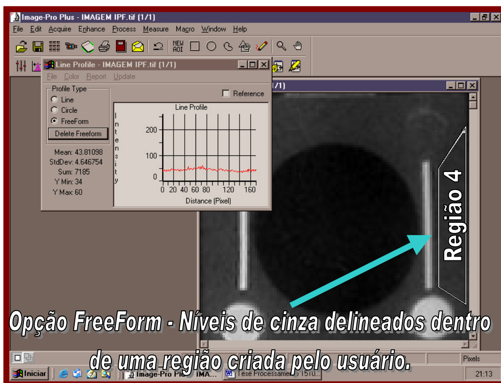
Figura IV.17 – Manipulação do sistema computacional Image-Pro para medição dos níveis de cinza da armação de teflon (região 4) através da ferramenta Line Profile .
