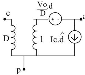
Figura 2.15 - Modelo do interruptor PWM para pequenos sinais.
