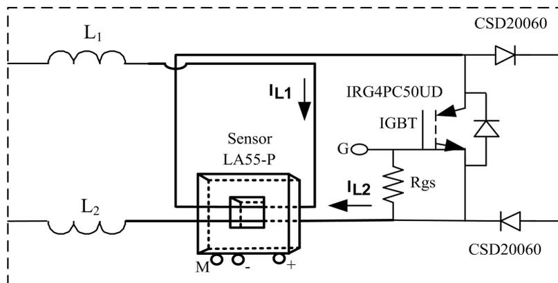
Figura 4.8 - Esquema de simulação com duas correntes no sensor hall.
