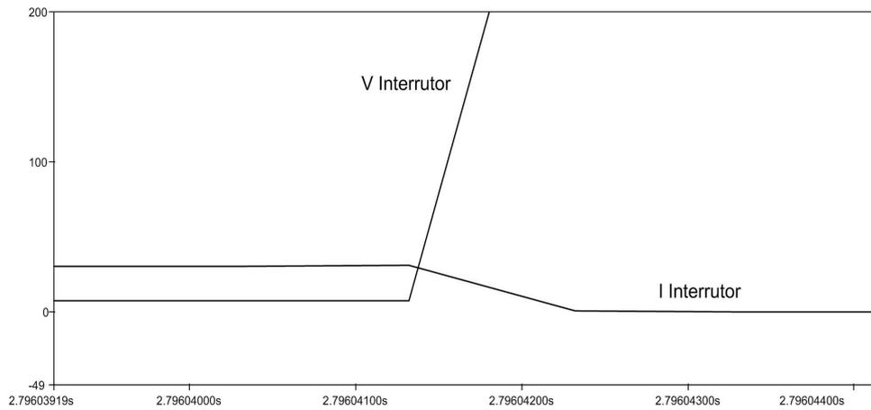
*Figura 4.5 - Correntes e tensão sobre o interruptor.*
