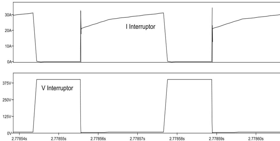
*Figura 4.13 - Corrente e tensão sobre o interruptor.*
