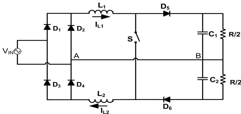
Figura 2.1 - Conversor dobrador de tensão.
