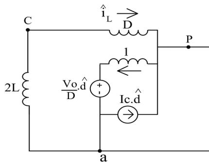
Figura 2.18 - Modelo do conversor dobrador de tensão simplificado.
