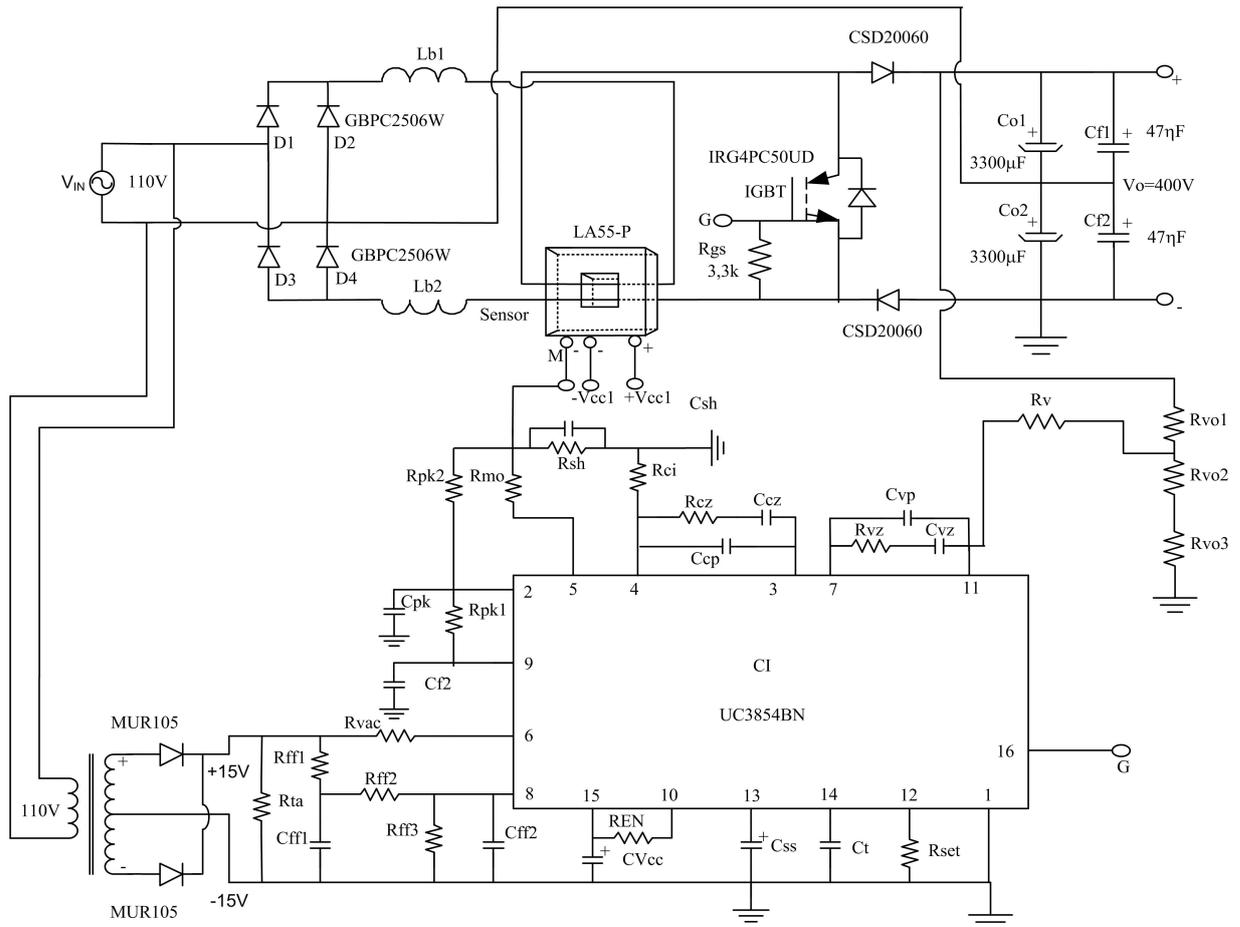
Figura 2.14 - Esquema de controle com UC 3854BN.
