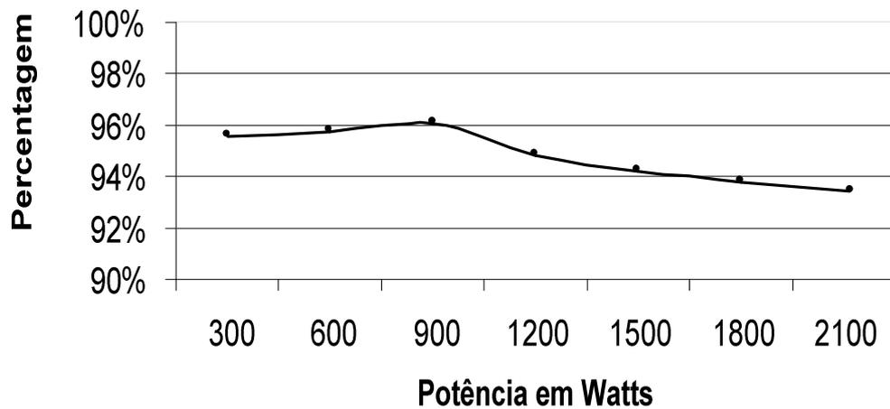
Figura 4.25 – Rendimento do conversor dobrador de tensão.
