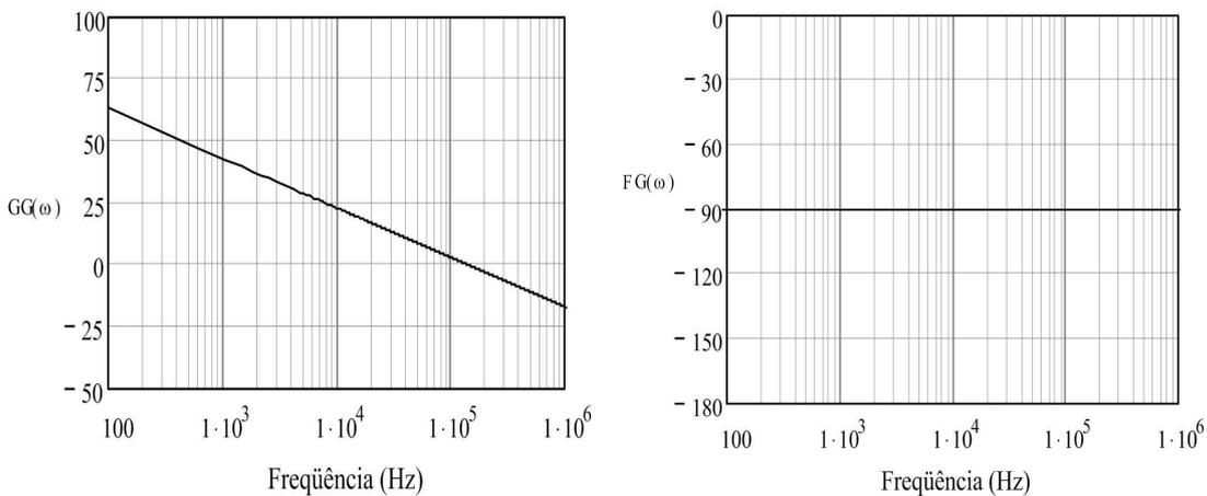
Figura 3.1 - Diagrama de Bode do conversor dobrador.
