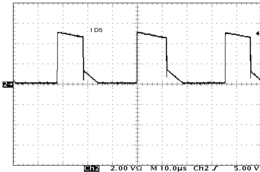
Figura 4.21 – Corrente sobre o diodo boost D<sub>5</sub> (10A/div, 10µs/div).
