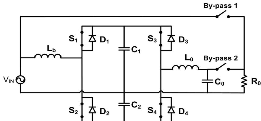
Figura 1.5 - Topologia do retificador e inversor meia ponte.
