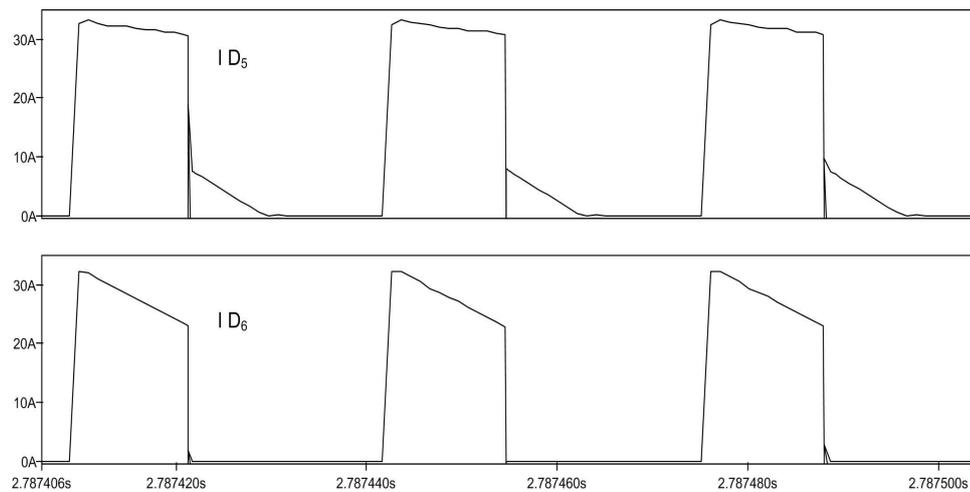
*Figura 4.4 - Correntes nos diodos  $D_6$  e  $D_5$ .*
