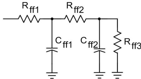
Figura 2.22 - Filtro de 2<sup>a</sup> ordem do compensador de *feedforward*.
