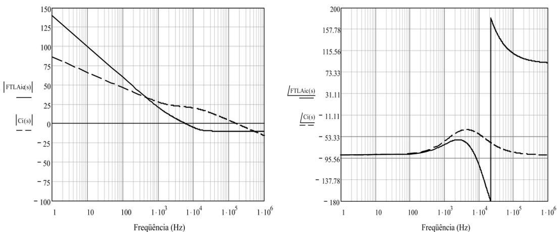
Figura 3. 3 - Diagrama de Bode da função de transferência  $FTLA_i(s)$  compensada.
