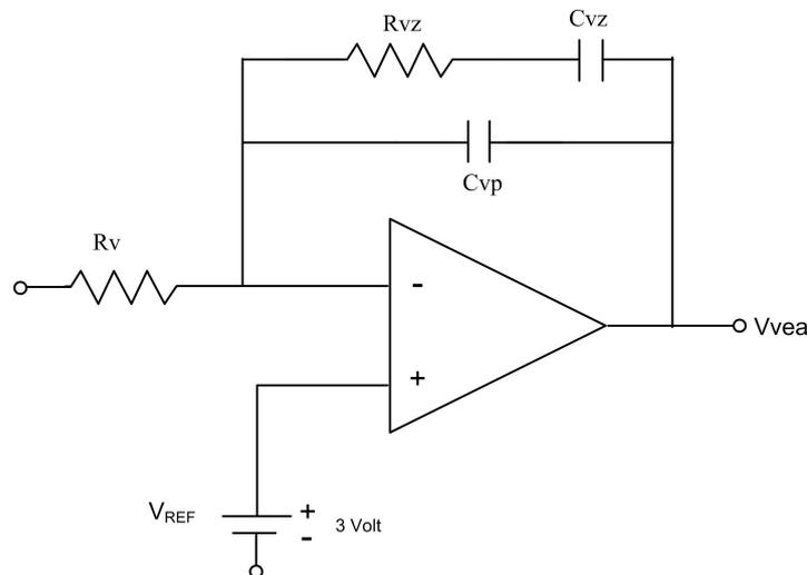
Figura 2.20 - (a) Esquema do compensador de tensão.
