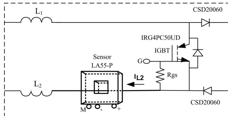
Figura 4.1 - Esquema de simulação com uma corrente no sensor hall.
