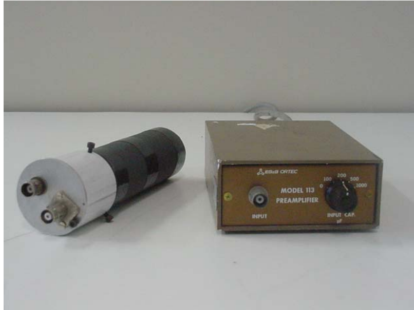
Figura 3.5a – Detector acoplado a fotomultiplicadora com divisor de tensão, e o pré amplificador utilizado.
