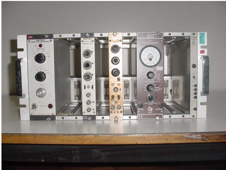
3.5b – Sistema NIM (bastidor e módulo)
