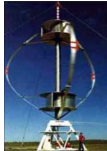
Figura 2.3: Aerogerador Darrieus . Fonte: CERPCH (2007).
