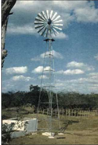
Figura 2.5: Aerogerador de pás múltiplas ou cata-ventos. Fonte: CERPCH (2007).
