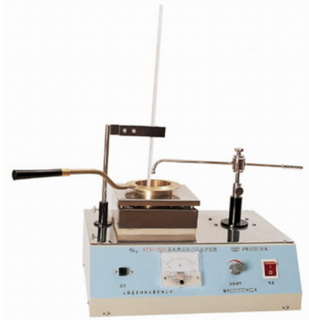
Figura 4.1: Ilustração de um Vaso aberto tipo Cleveland utilizado em ensaios de Ponto de Fulgor. [38]
