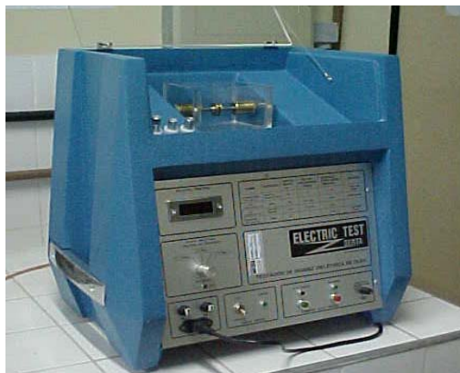
Foto 3: Equipamentos medidores de Rigidez Dielétrica, da “Eletric Test Seta – ETS”
