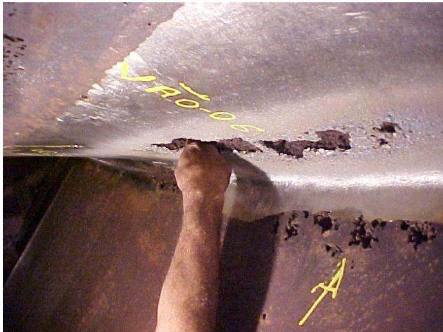
Figura 2.1 Erosão cavitacional em turbina hidráulica tipo Francis.
