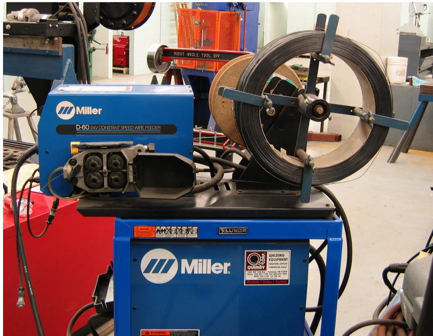
Figura 2.3 Exemplo de alimentador de arame utilizado na soldagem GMAW. ([http://commons.wikimedia.org/wiki/Image:Welding\\_wire\\_feeder-Miller-D60-side-triddle.jpg](http://commons.wikimedia.org/wiki/Image:Welding_wire_feeder-Miller-D60-side-triddle.jpg), julho, 2007.).
