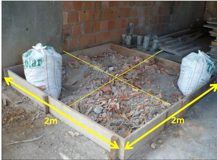
Figura 9 – Área reservada no canteiro de obras para a coleta das amostras.
