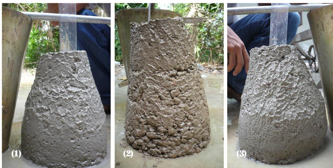
Figura 20 – Ensaio de abatimento do Tronco de cone da amostra E3(1), F1(2) e G3(3)
