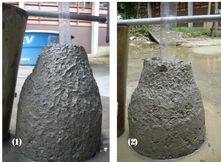
Figura 18 – Ensaio de abatimento do Tronco de cone da amostra H3 (1) e I3 (2)
