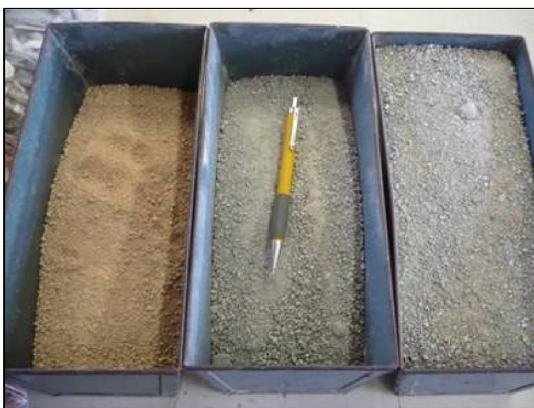
Figura 2 - Porção miúda do resíduo após peneiramento na 4,8mm.
