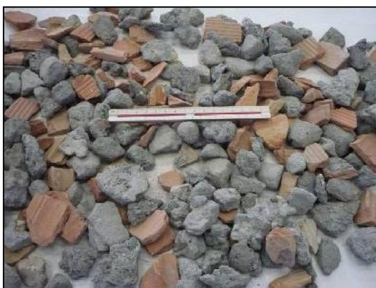
Figura 3 – Porção graúda do resíduo após peneiramento na 4,8mm.
