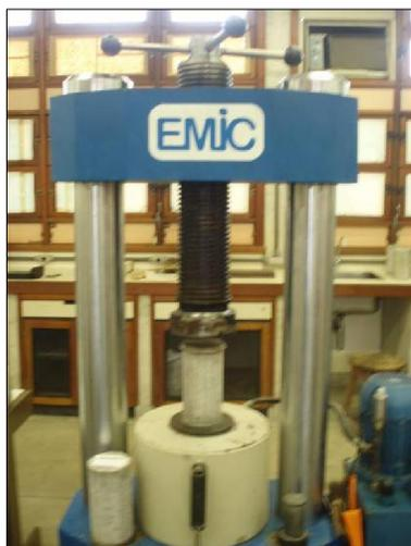
Figura 4 – Máquina de rompimento de corpo-de-prova por compressão simples
