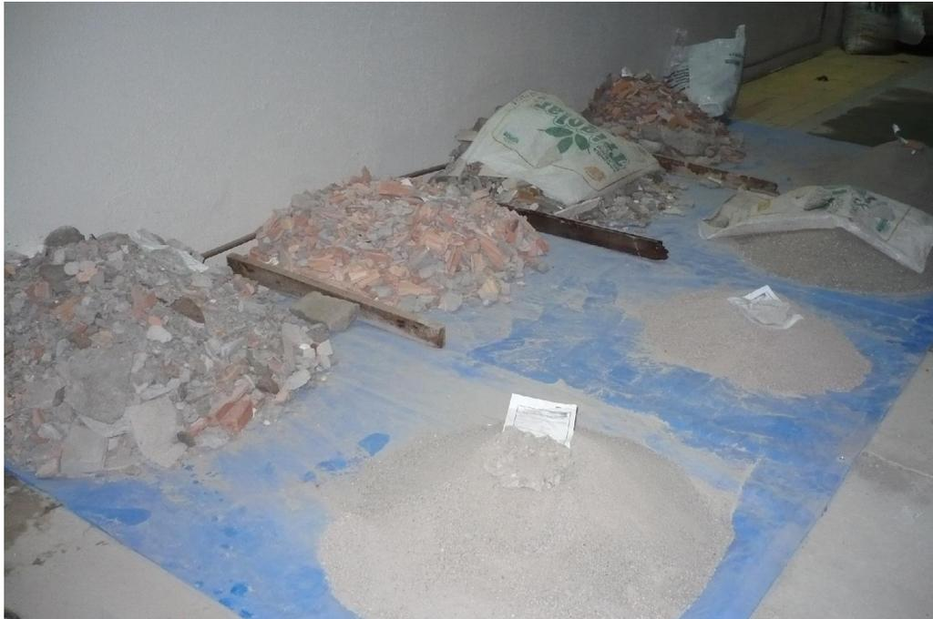
Figura10 - Amostras separadas na peneira 4,8mm em miúdo e graúdo
