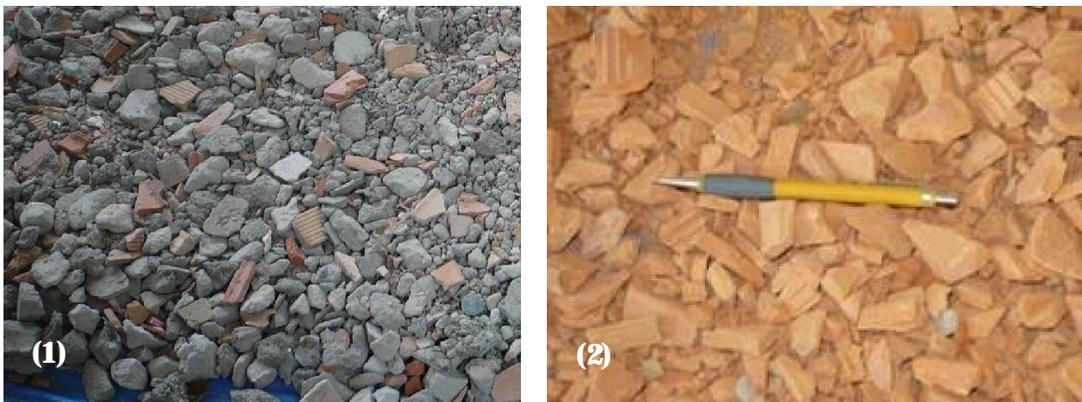
Figura 15 – Amostras A2 (1) e F1(2) após britagem manual
