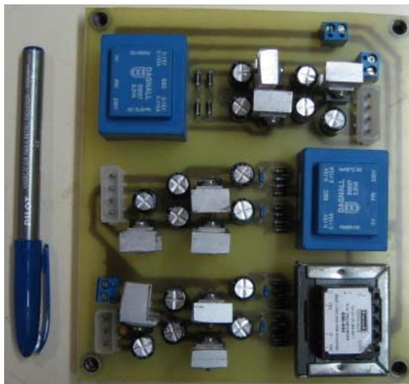
Figura A.3. Placa de Alimentação auxiliar.
