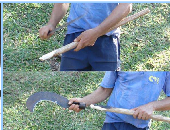
Figura 21 – Agricultor confeccionando cabo de ferramenta de guajuvira ( Patagonula americana ) no município de Anchieta/SC.
