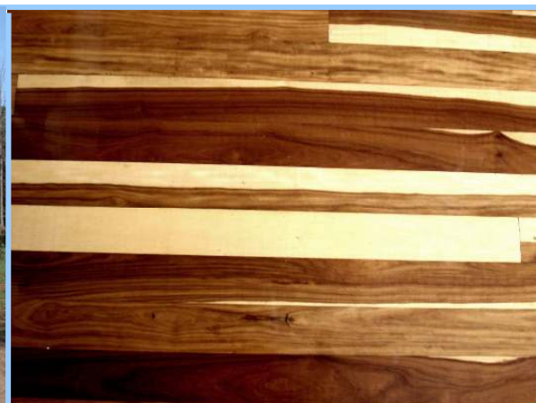
Figura 9 – Assoalho feito com grápia ( Apuleia leiocarpa ) (tábua central toda amarela) e com guajuvira ( Patagonula americana ) (tábuas com duas cores).
