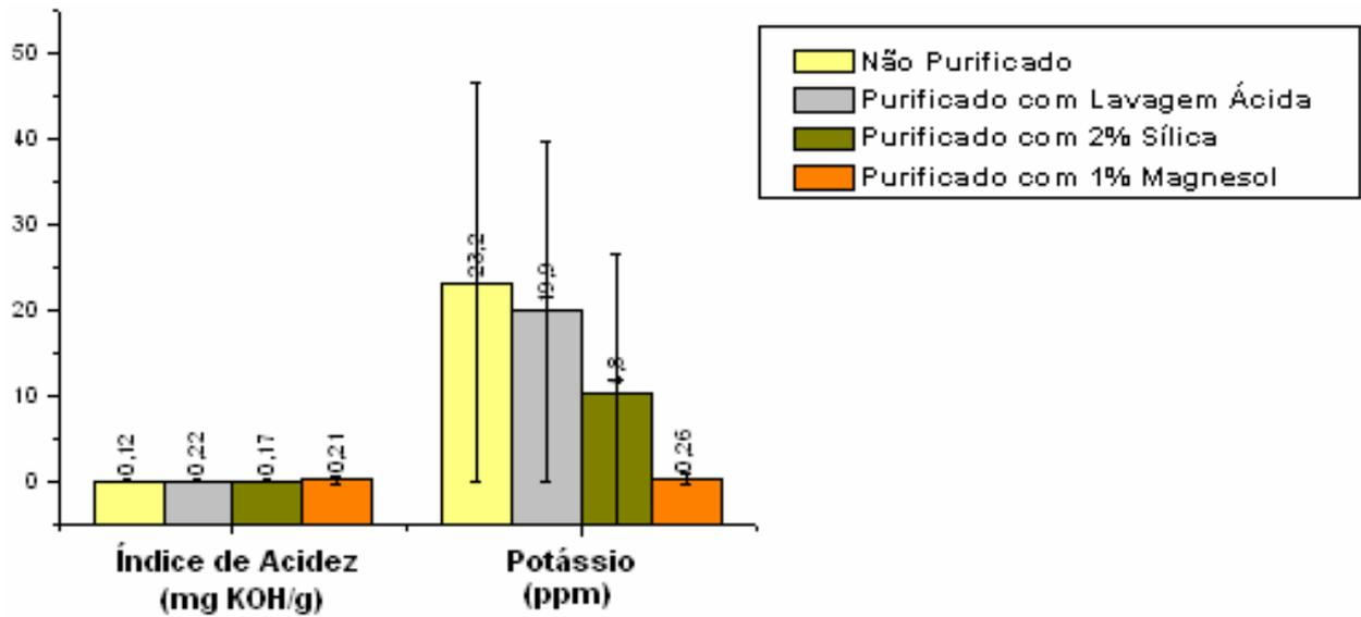
**Figura 10:** Índice de acidez e teor de potássio para amostras não purificada e purificada com diferentes tratamentos
