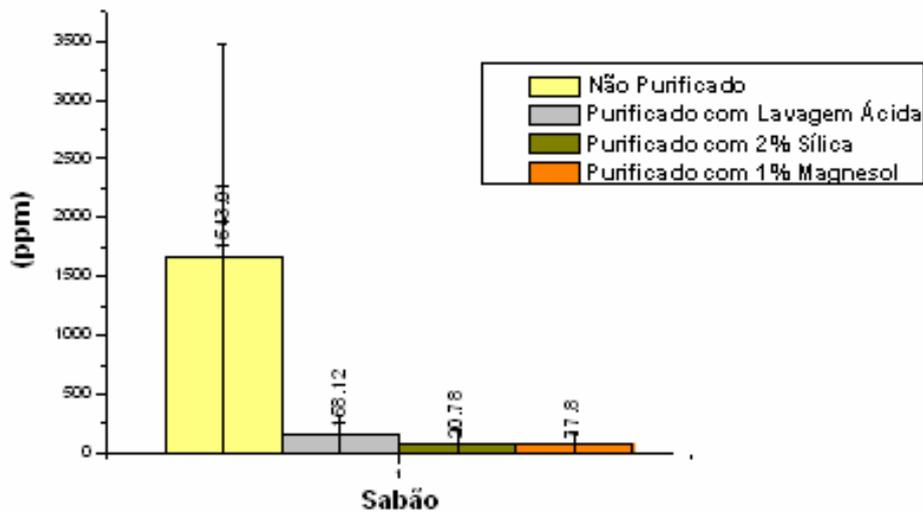
**Figura 11:** Teor de sabão para as amostras não purificada e purificada com diferentes tratamentos
