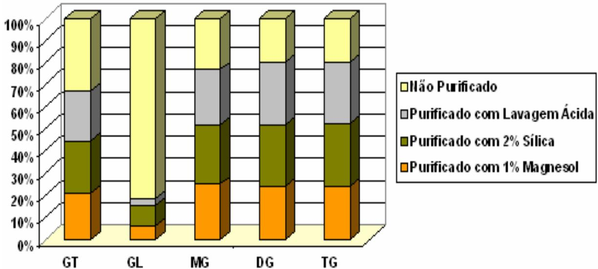
**Figura 12:** Concentração de glicerina total (GT), glicerina livre (GL), monoacilgliceróis (MG), diacilgliceróis (DG) e triacilgliceróis (TG) em amostras não purificadas e purificadas com diferentes tratamentos
