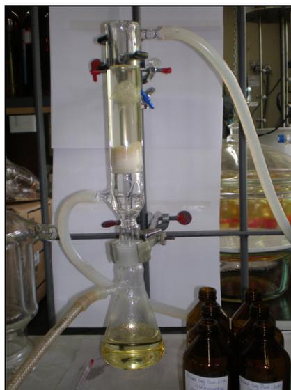
**Figura 7:** Sistema de purificação em leito fixo utilizado
