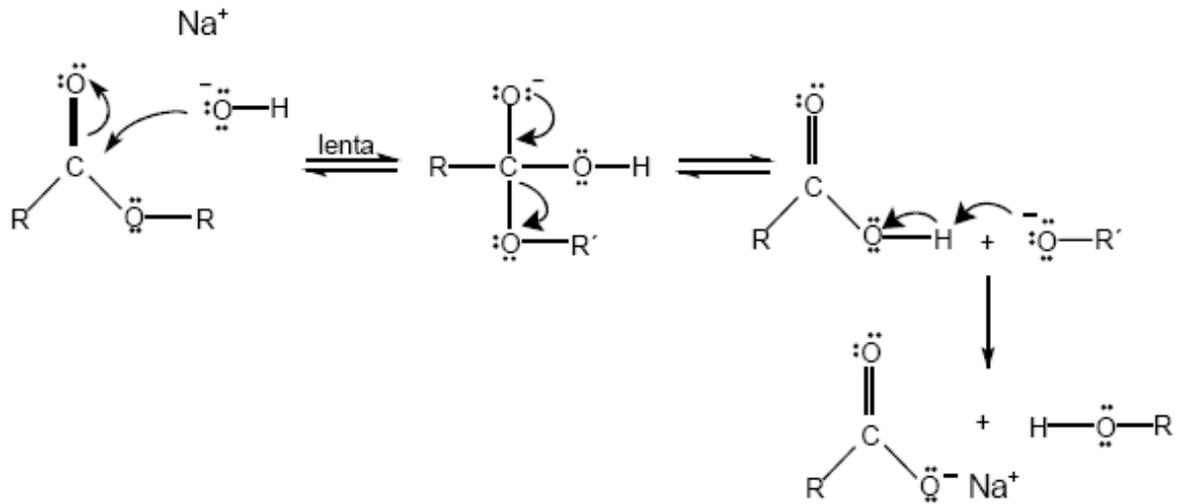
**Figura 4:** Mecanismo da reação de saponificação de triacilgliceróis
