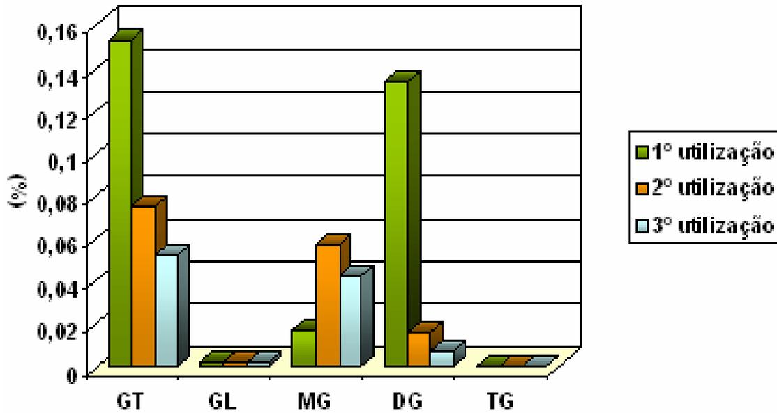
**Figura 19:** Concentração de glicerina total (GT), glicerina livre (GL), monoacilgliceróis (MG), diacilgliceróis (DG) e triacilgliceróis (TG) obtidos após reutilização do adsorvente Magnesol<sup>®</sup>
