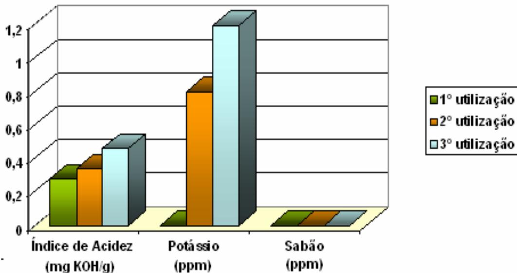
**Figura 17:** Índice de acidez, teor de sabão e potássio obtidos após reutilização do adsorvente Magnesol<sup>®</sup>
