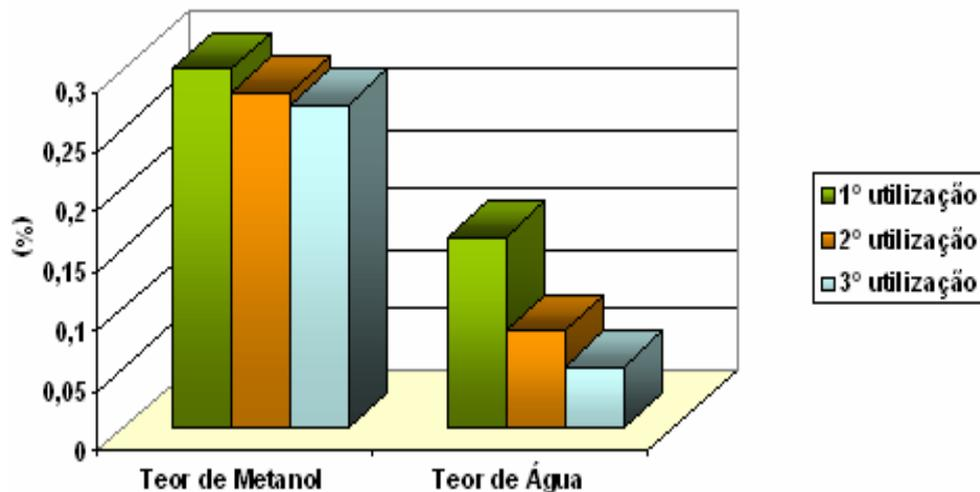
**Figura 18:** Teor de metanol e teor de água, obtidos após reutilização do adsorvente Magnesol®
