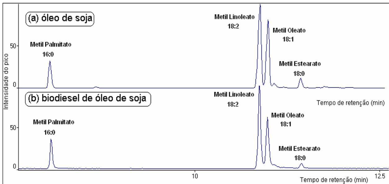
**Figura 9:** Cromatograma do íon total da amostra de óleo de soja derivatizado (a) e do biodiesel produzido (b). *Condições cromatográficas descritas no texto (item 3.3.8)*
