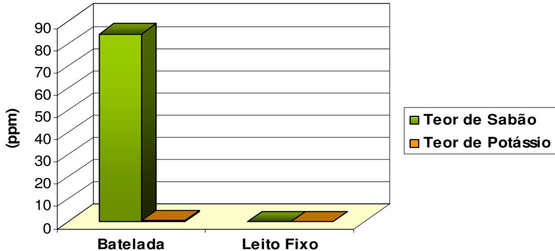
**Figura 15:** Teor de sabão e potássio para amostras de biodiesel purificadas em batelada e em leito fixo
