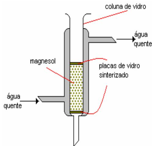
**Figura 6:** Coluna de adsorção para a purificação do biodiesel usando Magnesol<sup>®</sup> em leito fixo
