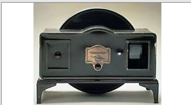
Fig 04. A Televisão mecânica inglesa de 1926, tinha uma pequena tela posicionada à direita e media 56 cm de altura. Este aparelho não conseguia transmitir som e imagem ao mesmo tempo (TAMBINI, 1999, p.94).
