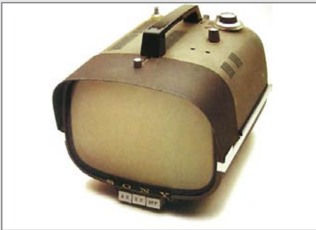
Fig 17. Sony TV8-301, 1959. Com design original e tecnicamente inovadora, a TV8-301 foi a primeira televisão que continha transistores de recepção miniaturizados (TAMBINI, 1999, p.96).
