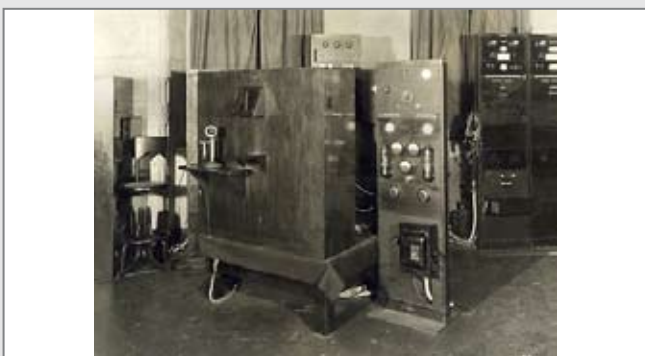
Fig 05. Aparelho receptor utilizado na primeira demonstração americana de Televisão em 07 de abril de 1927 (Disponível em: < http://www.corp.att.com/history/television/photo_tvequipment.html >. Acessado em 25 de Fev de 2007).
